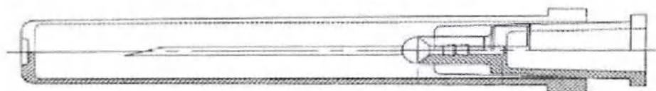
Рисунок 8 - Схема общего вида защитного колпачка с иглой
