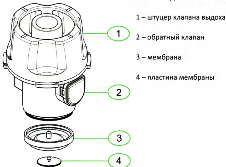
Рисунок 3-1. Сборка клапана выдоха.
