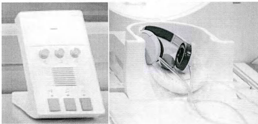
Рисунок 30 – Устройство голосовой связи «оператор-пациент» с динамиком, наушниками и сигнальным устройством («груша»)
