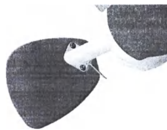
Рисунок 23. Установка подручников на основное плечо
