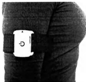
Рисунок 34. Правильное присоединение датчика движения PABLO
