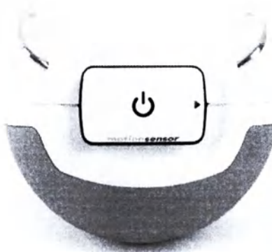
Рисунок 25. Правильное центрование датчика движения PABLO на манипуляторе PABLO Multiball
