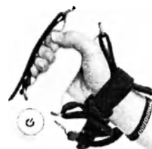
Рисунок 29. Присоединение устройства PABLO к руке
