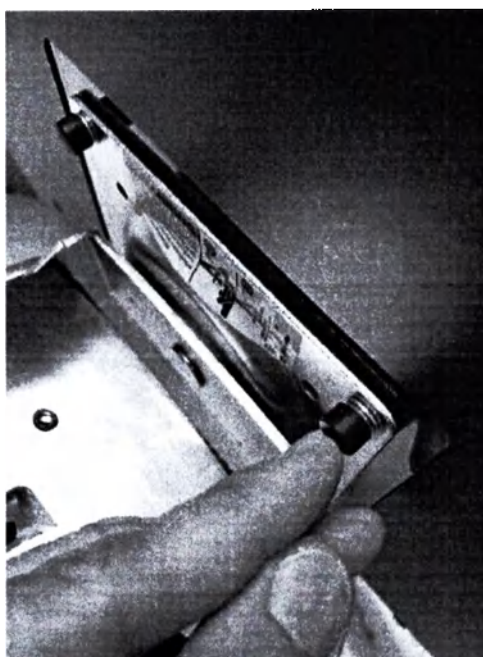
Рисунок 12. Крепление черных крышек
