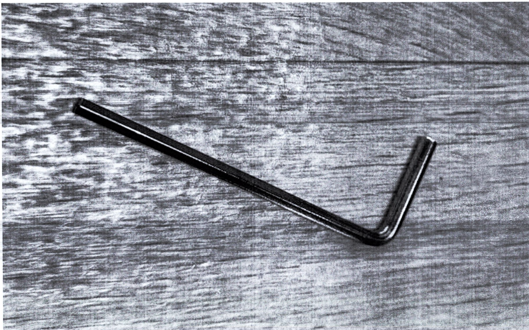
Шестигранная отвертка (для установки манипулятора PABLO Multiboard)
