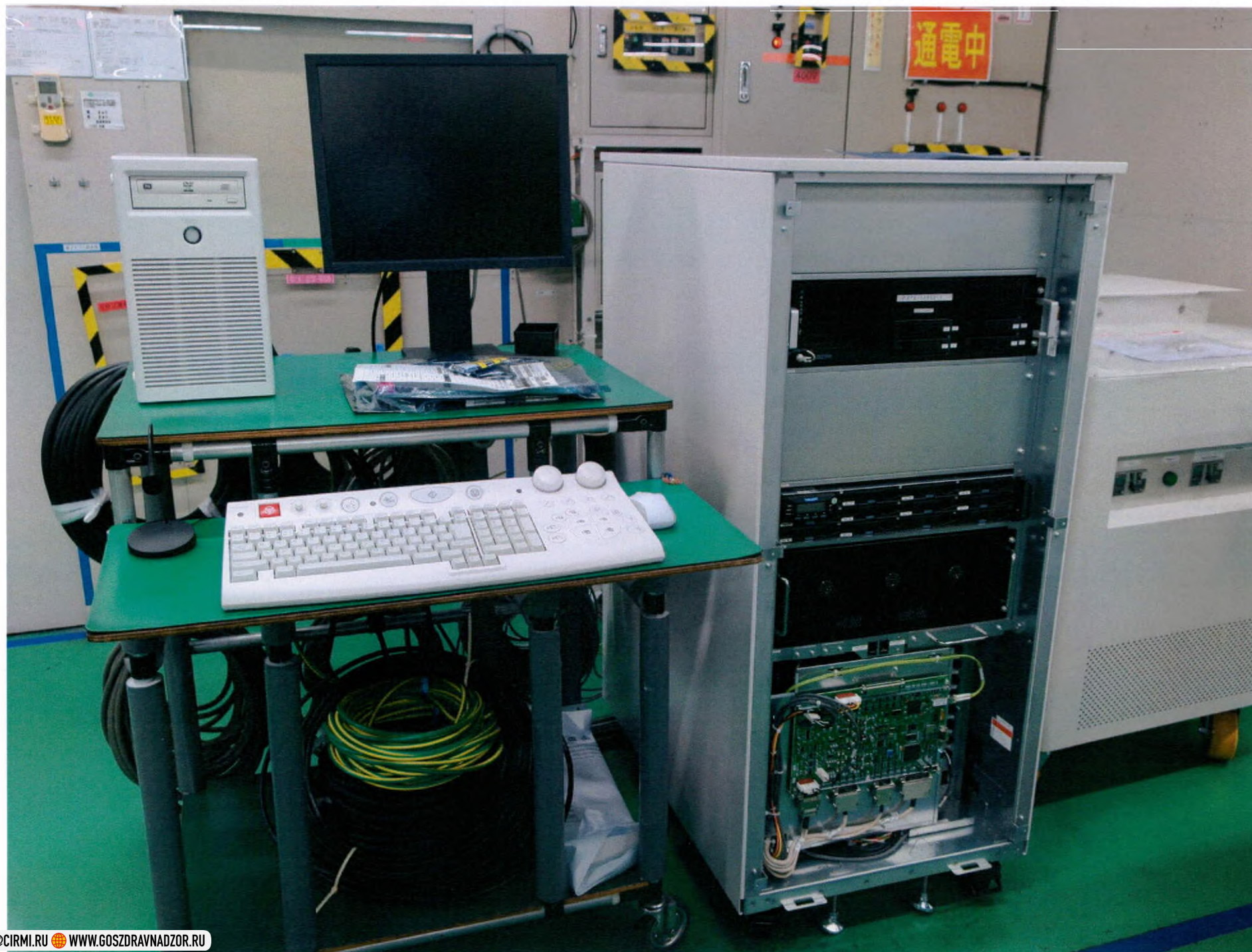
3. Консоль: Монитор; Блок ЦПУ (шкаф STNAVI BOX, блок реконструкции CON BOX); Клавиатура; Мышь компьютерная; Громкоговоритель; Микрофон; Основное ПО системы
