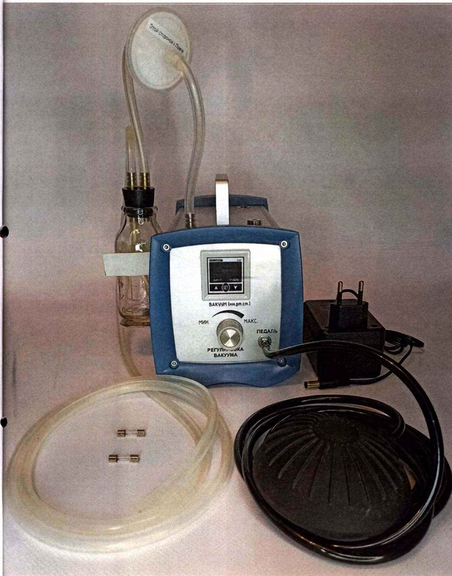
Рис.1. Помпа "GENINTER®" с регулируемым вакуумом для аспирации ооцитов по ТУ 32.50.13-001-72923880-2022, внешний вид в сборе.
