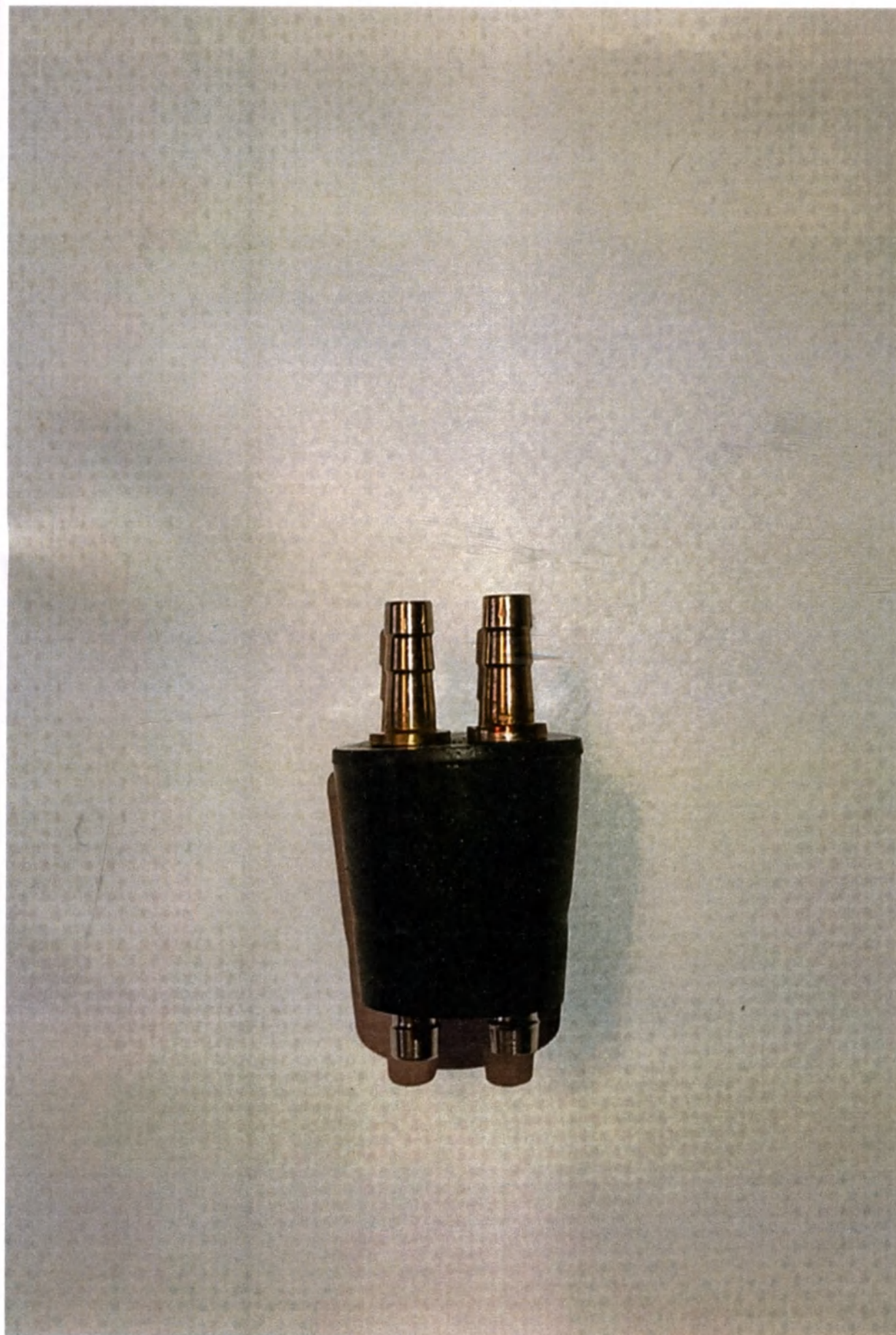
Рис.11. Пробка резиновая, диаметр – 31 мм с 2-мя штуцерами диаметром 6 мм.
