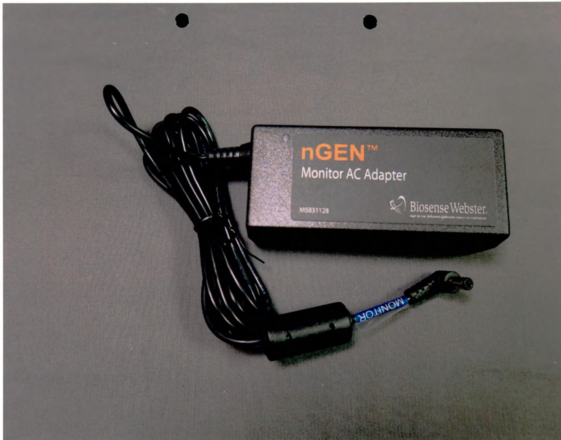
Рис. 63 – Монитор дополнительный nGEN, в составе: Блок питания монитора nGEN, длина 2 м.
