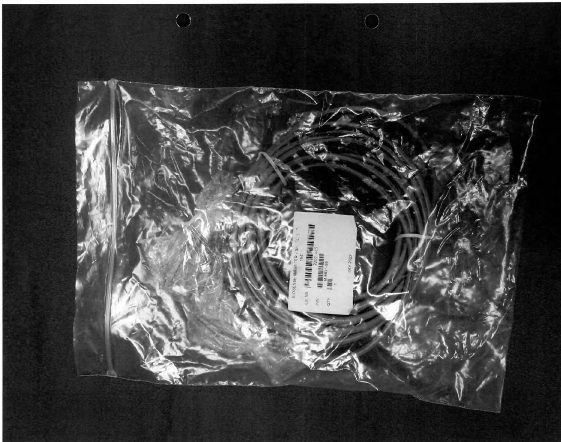
Рис. 34 – Кабель последовательной передачи данных RS232, соединяющий монитор nGEN и электрофизиологическую систему, длина 7,6 м. Потребительская упаковка
