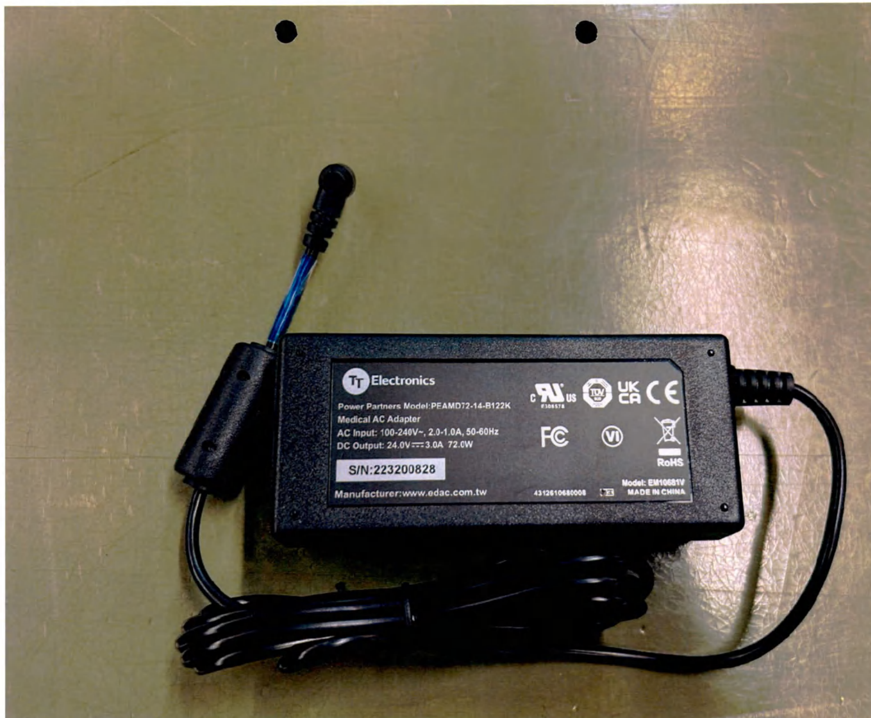
Рис. 64 – Монитор дополнительный nGEN, в составе: Блок питания монитора nGEN, длина 2 м.
