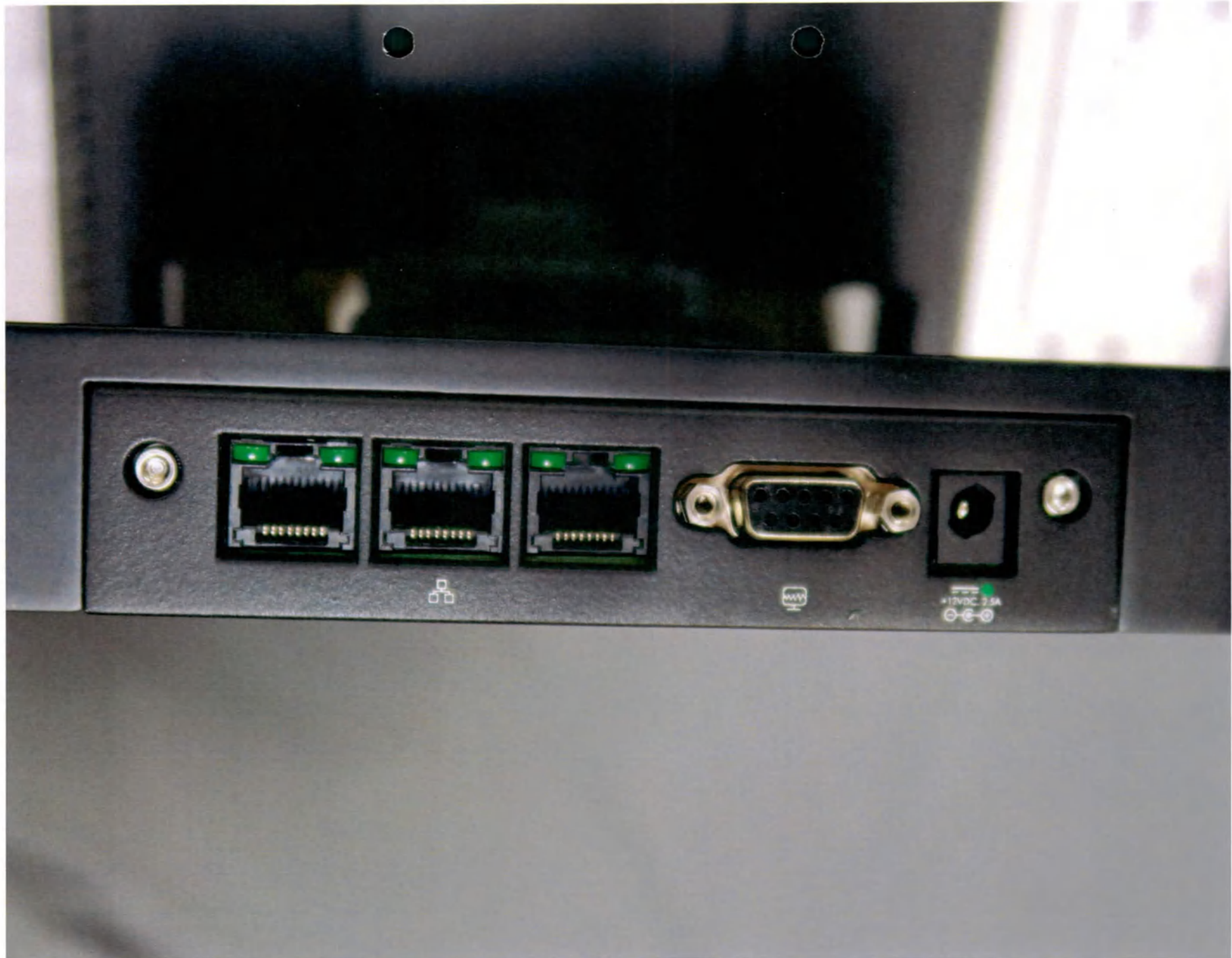
Рис. 15 – Монитор pGEN, в составе: Стойка для монитора pGEN. Разъемы на панели
