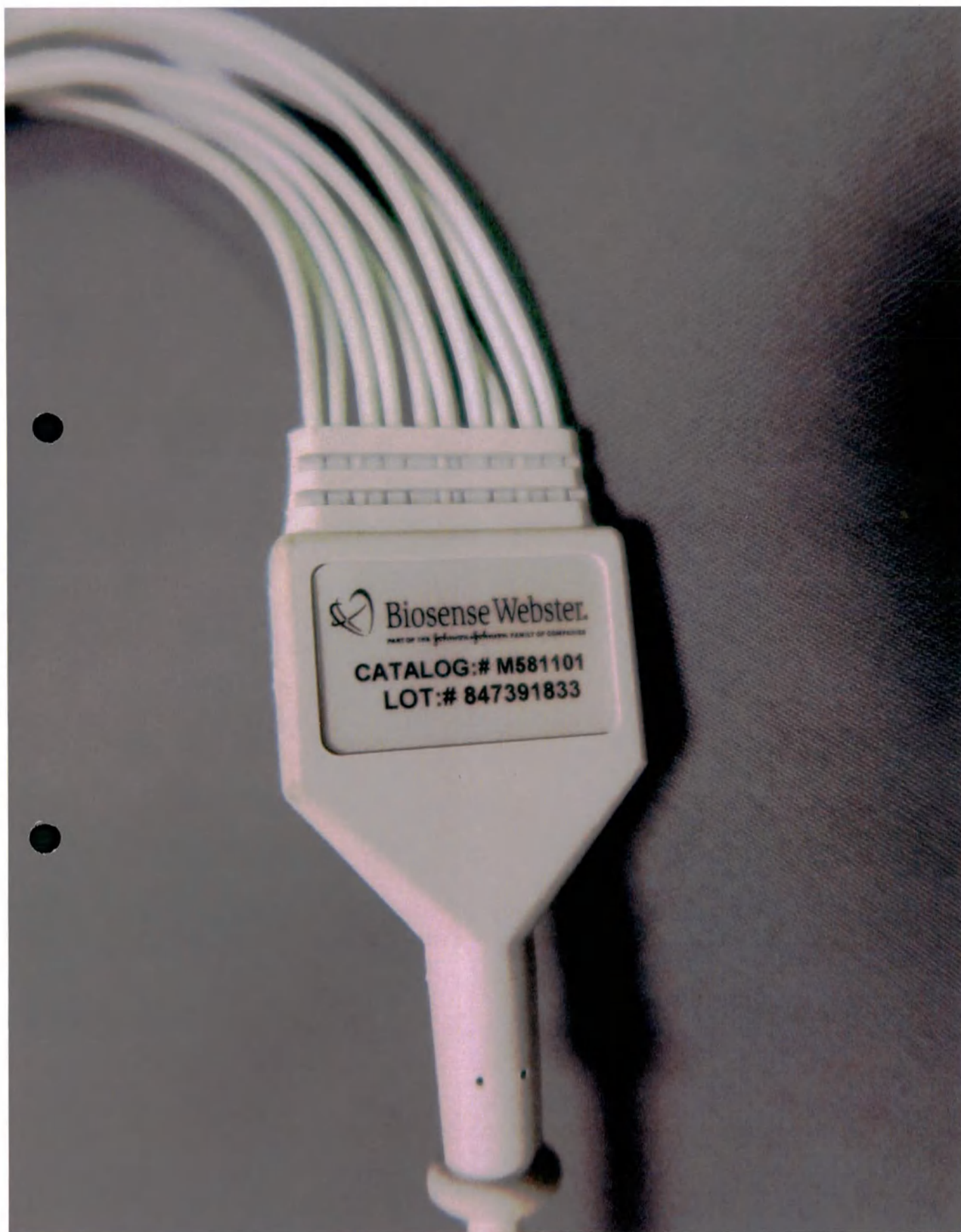
Рис. 38 – Кабель ЭКГ соединительный, длина 2 м
