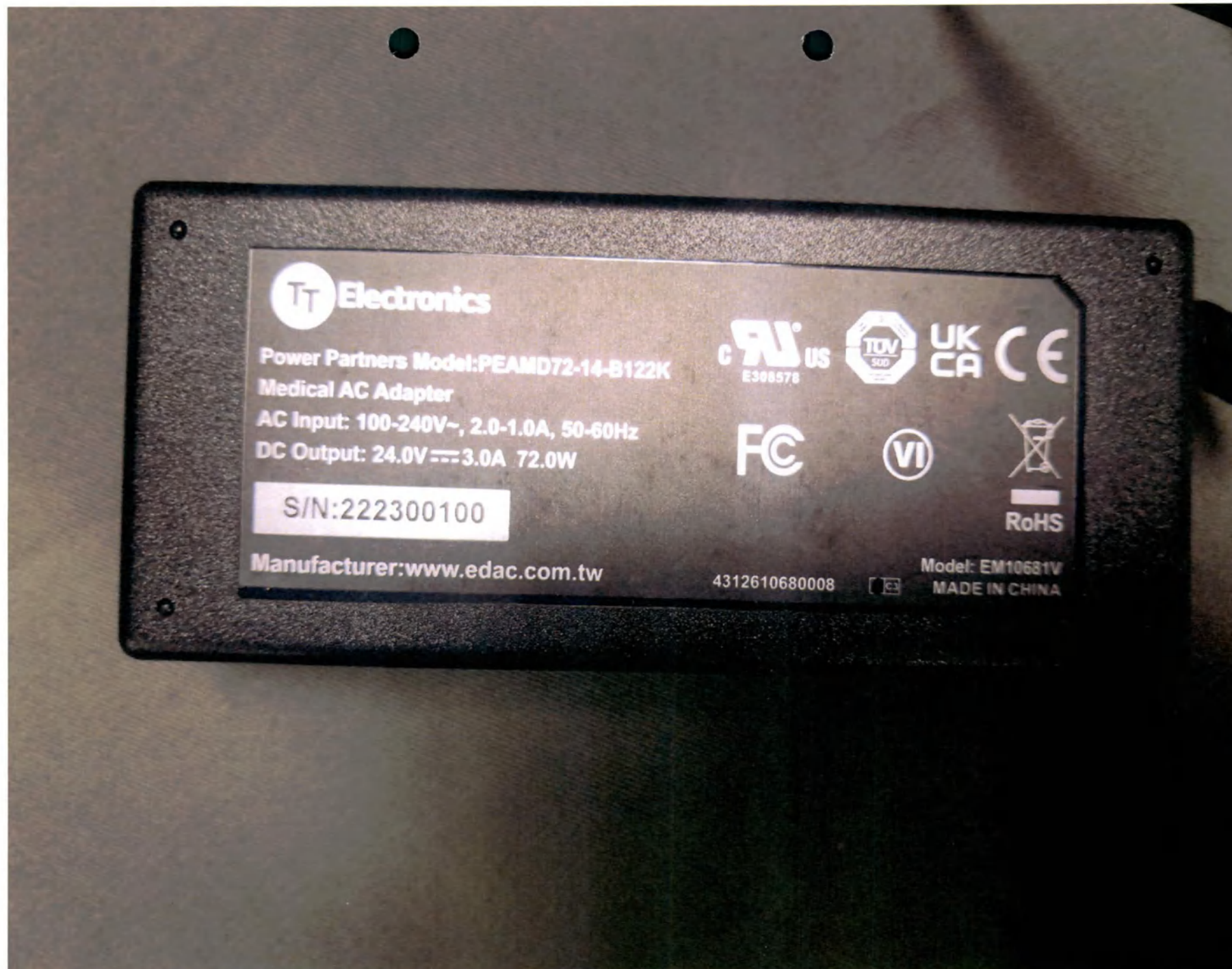
Рис. 48 – Адаптер питания переменного тока насоса ирригационного nGEN. Маркировка на образце.
