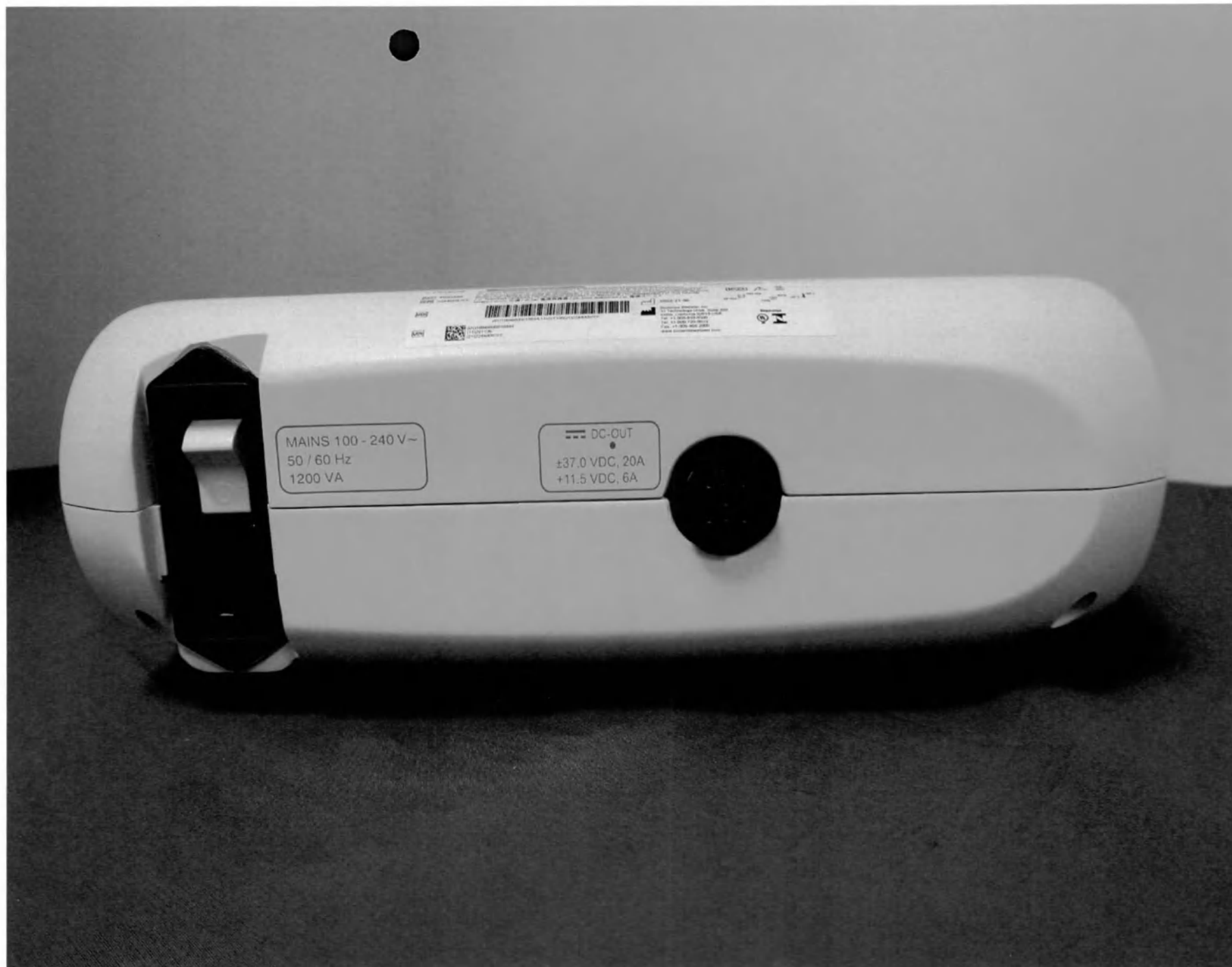
Рис. 6 – Блок питания генератора nGEN. Задняя панель
