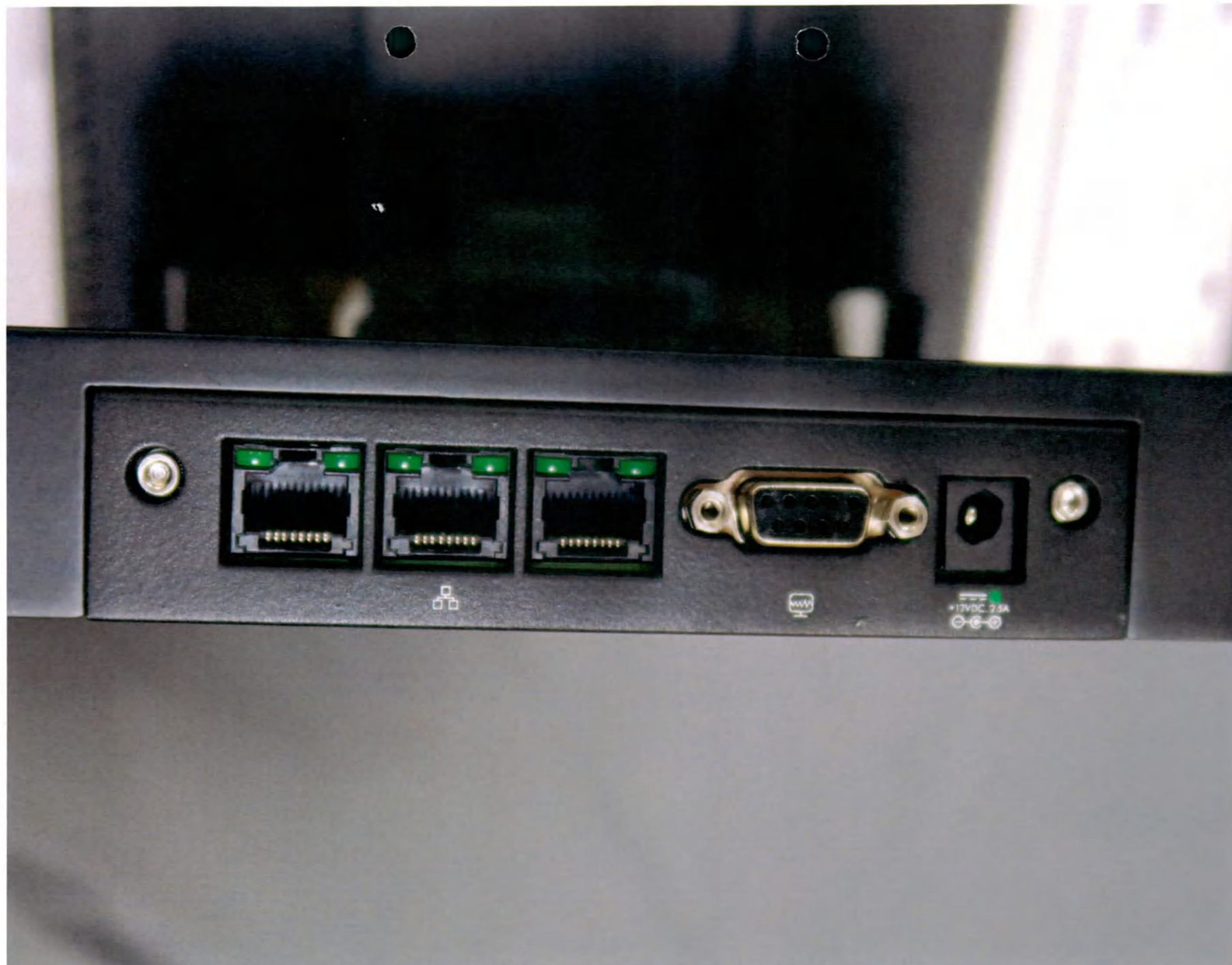
Рис. 61 – Монитор дополнительный pGEN, в составе: Стойка для монитора pGEN. Разъемы на панели
