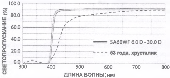
Рисунок 2: Кривые спектрального коэффициента светопропускания
