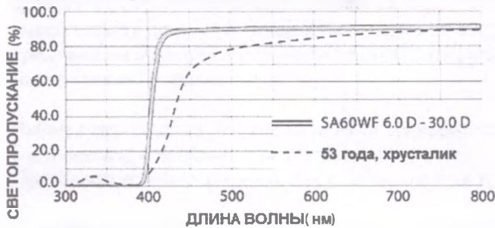
Рисунок 2: Кривые спектрального коэффициента светопропускания
