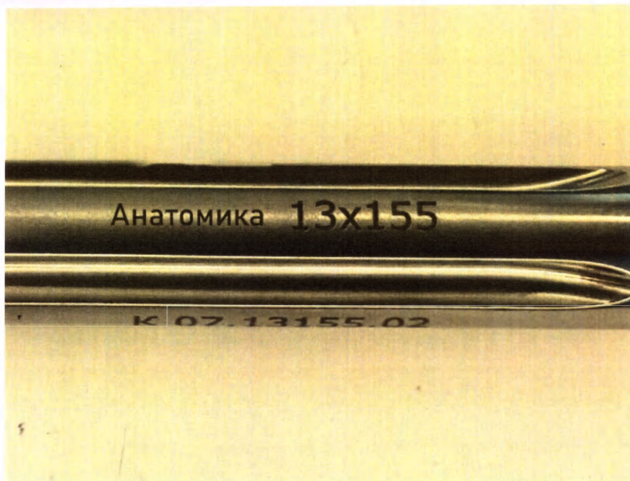
Фото 4. «Имплантаты для эндопротезирования коленного сустава по ТУ 32.50.22-011-74573326-2023»: образец маркировки, нанесенной на имплантат
