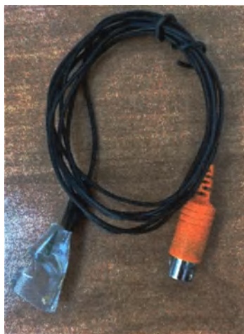
Рис. 23. Кабель для соединения слухового аппарата с программатором для программирования.
