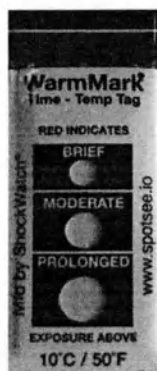
Рисунок 8 – Общий вид температурного индикатора 10 °C (WarmMark, модель 51017) – не активированный
