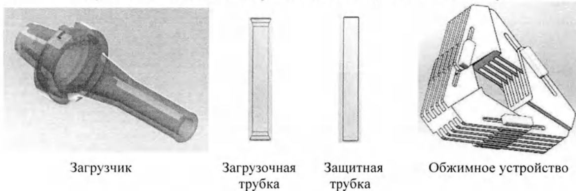
Рисунок 4 – Схематичное изображение системы доставочного катетера
