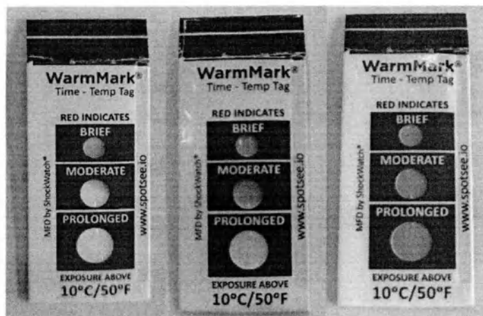
Рисунок 9 – Активированный индикатор (окошки температурного индикатора под воздействием температуры, окрашены) – НЕ ИСПЛЬЗУЙТЕ ИЗДЕЛИЕ!
