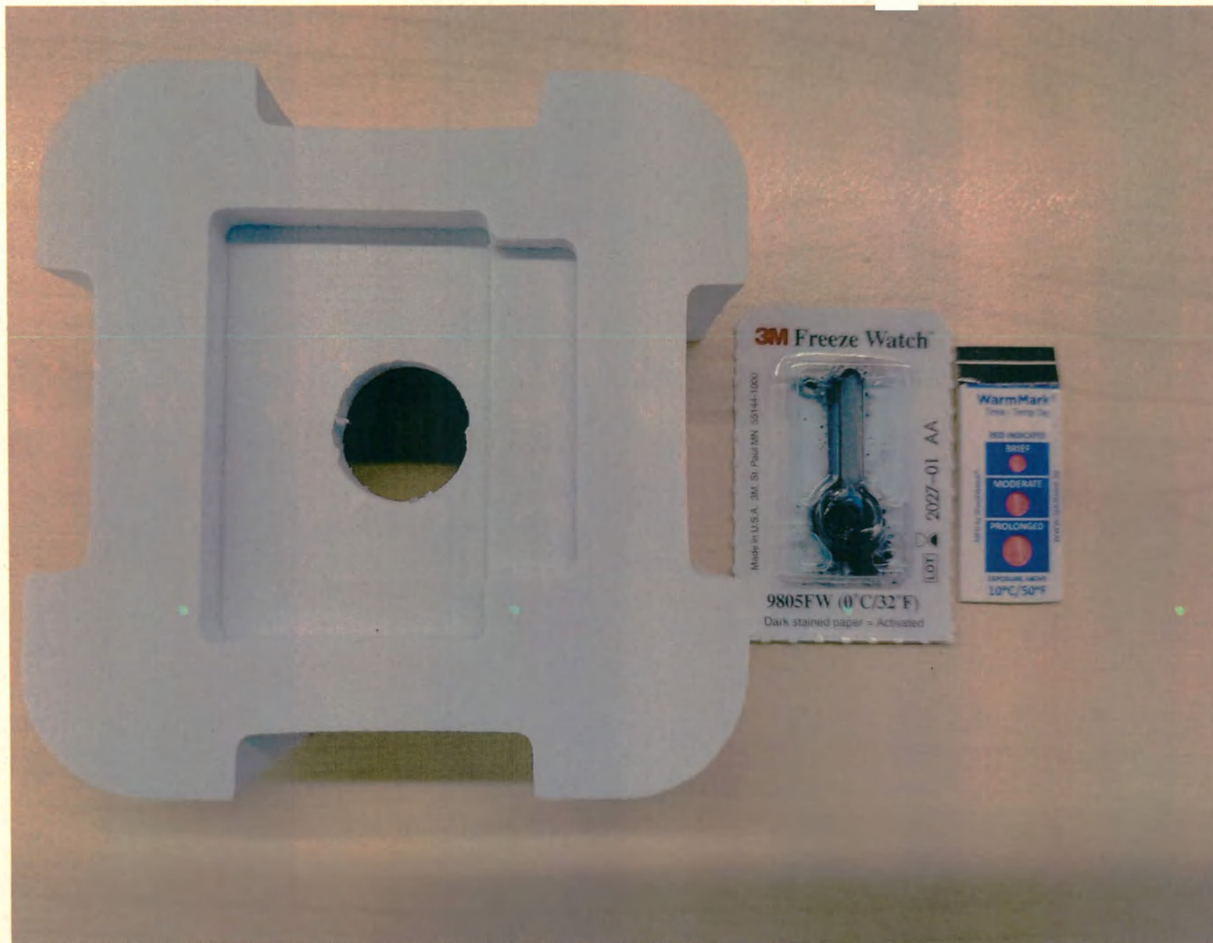
Фотография 12 – Активированный Температурный индикатор 10 °C (WarmMark, модель 51017) (окошки температурного индикатора под воздействием температуры, окрашены) и Активированный Температурный индикатор 0 °C (3M Freeze Watch™, модель 9805FW) (шарик красителя лопнул в индикаторе температуры и белая бумага загрязнена)
