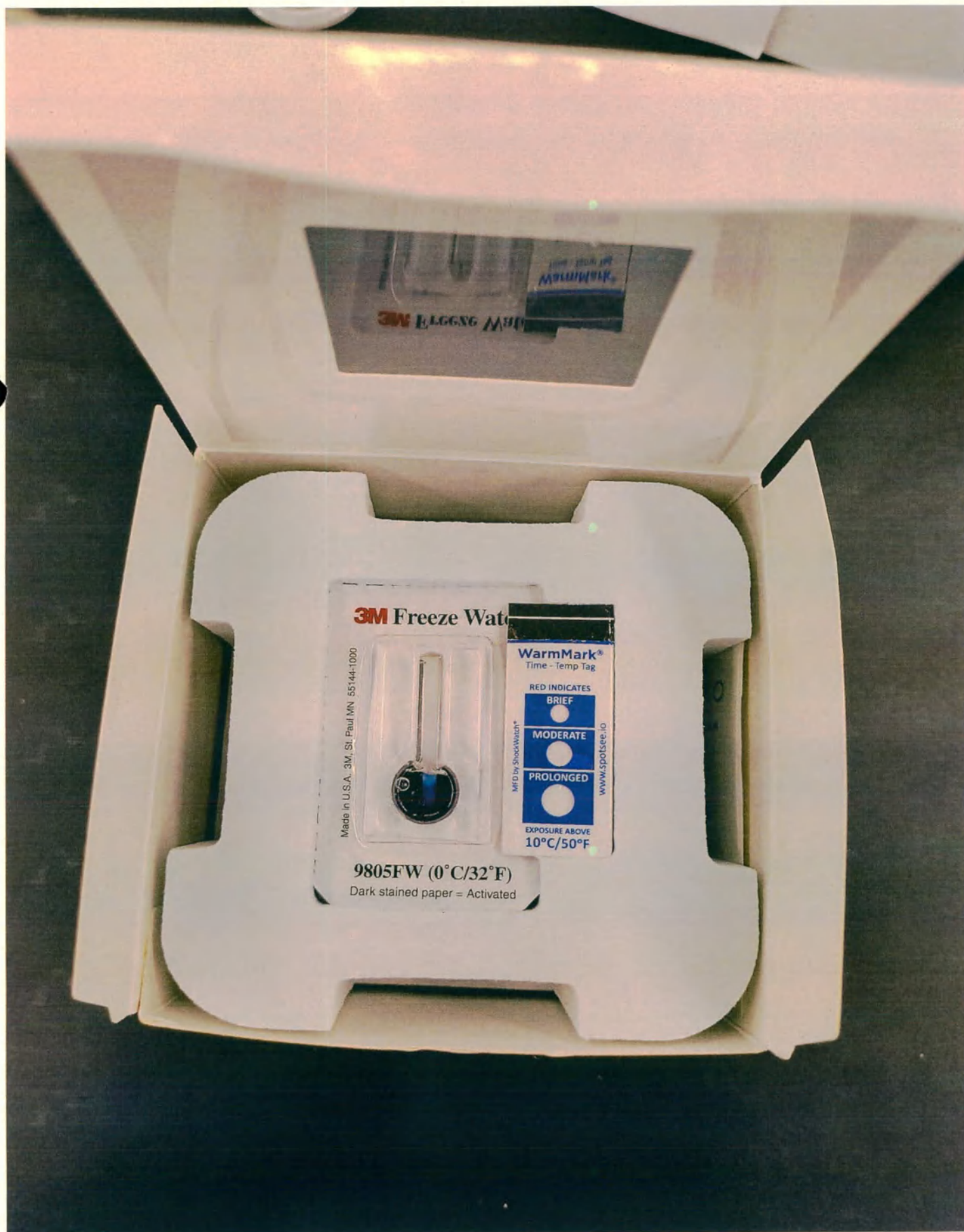
Фотография 11 – Температурный индикатор 10 °C (WarmMark, модель 51017) и Температурный индикатор 0 °C (3M Freeze Watch™, модель 9805FW) во вторичной (внешней) упаковке клапана
