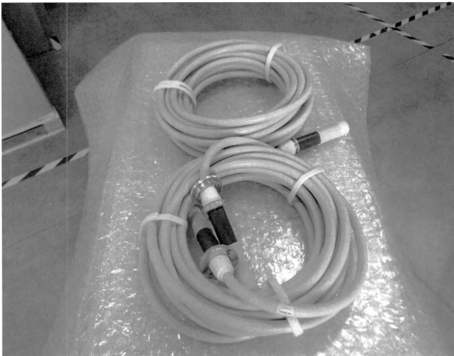
Комплект высоковольтных кабелей:
