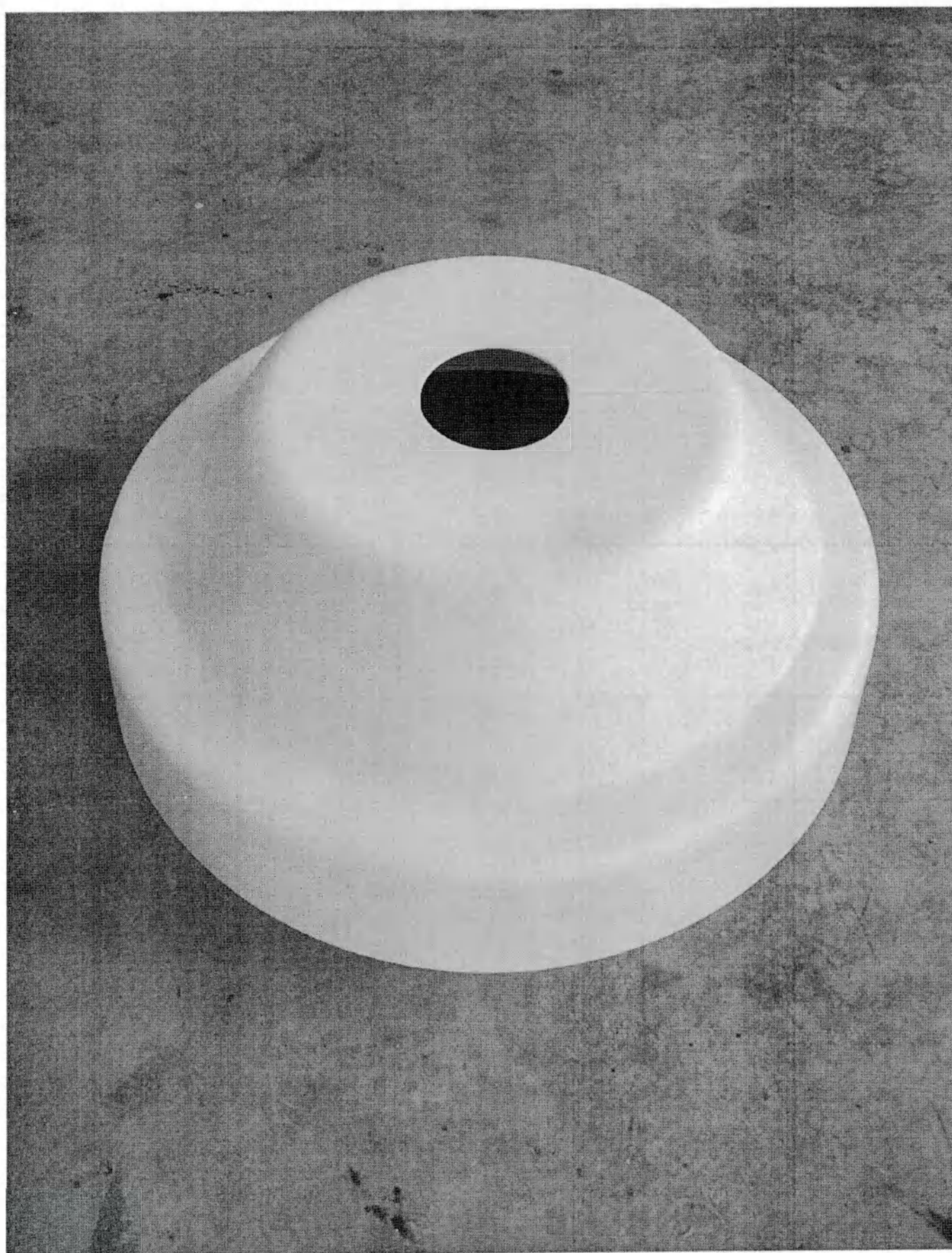
Колпак выпуклый диаметром 110,0 мм
