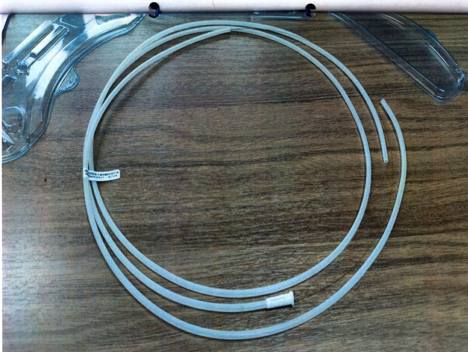
1.5 Проводник с датчиком давления OmniWire, длина 185 см, диаметр 0.36 мм, с прямым наконечником. Трубка проводник
