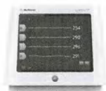
Figura 2. Display del generatore di RF per denervazione renale Symplicity G3™, con esempio di schemata di monitoraggio dell'impedenza
