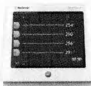
Afbeelding 2. Representatief beeld van de SymplectiC G3™ RF-generator voor renale denervatie met het scherm dat wordt weergegeven voor de impedantiebewaking
