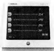
Figura 2. Imagem representativa do gerador de RF de desnervação renal Symplicity G3™ exibindo a tela de monitoração da impedância
