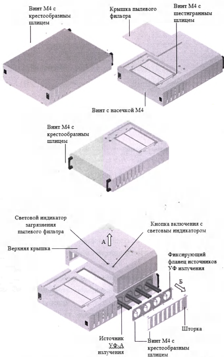
Рисунок 6 - Разборка медицинского изделия для замены источников УФ-А излучения
