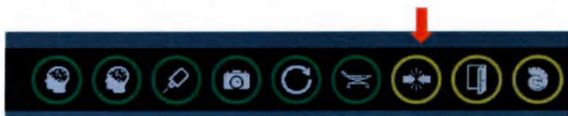
Рисунок 2-7. Индикатор обнаружения столкновения на интерфейсе пользователя
