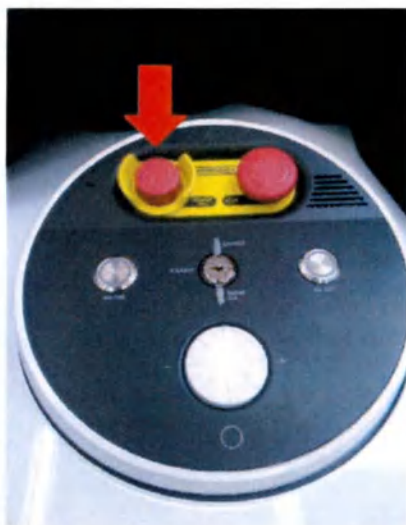
Кнопка аварийного отключения питания на консоли
