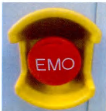
Рисунок 2.2.1. Кнопка аварийного отключения питания на БРП (слева) и на консоли управления (справа).
