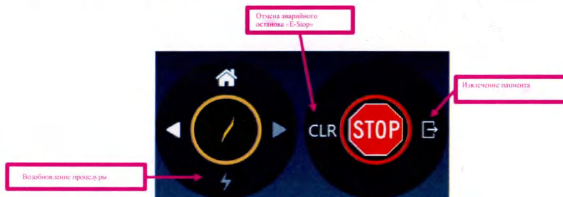
Рисунок 8.8.1. Значок «E-Stop» и колесо рабочего процесса
