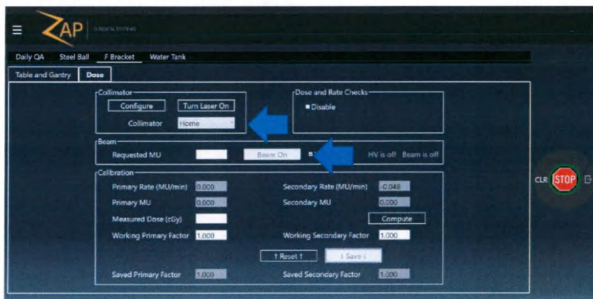
Рисунок 3-20. Страница F Bracket (F-образный кронштейн), вкладка Dose (Доза). Стрелки указывают на поля ввода для выбора коллиматора и задания экспонирования
