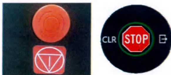
Рисунок 2.1.1. Кнопка E-Stop (слева) и значок пользовательского интерфейса (справа)
