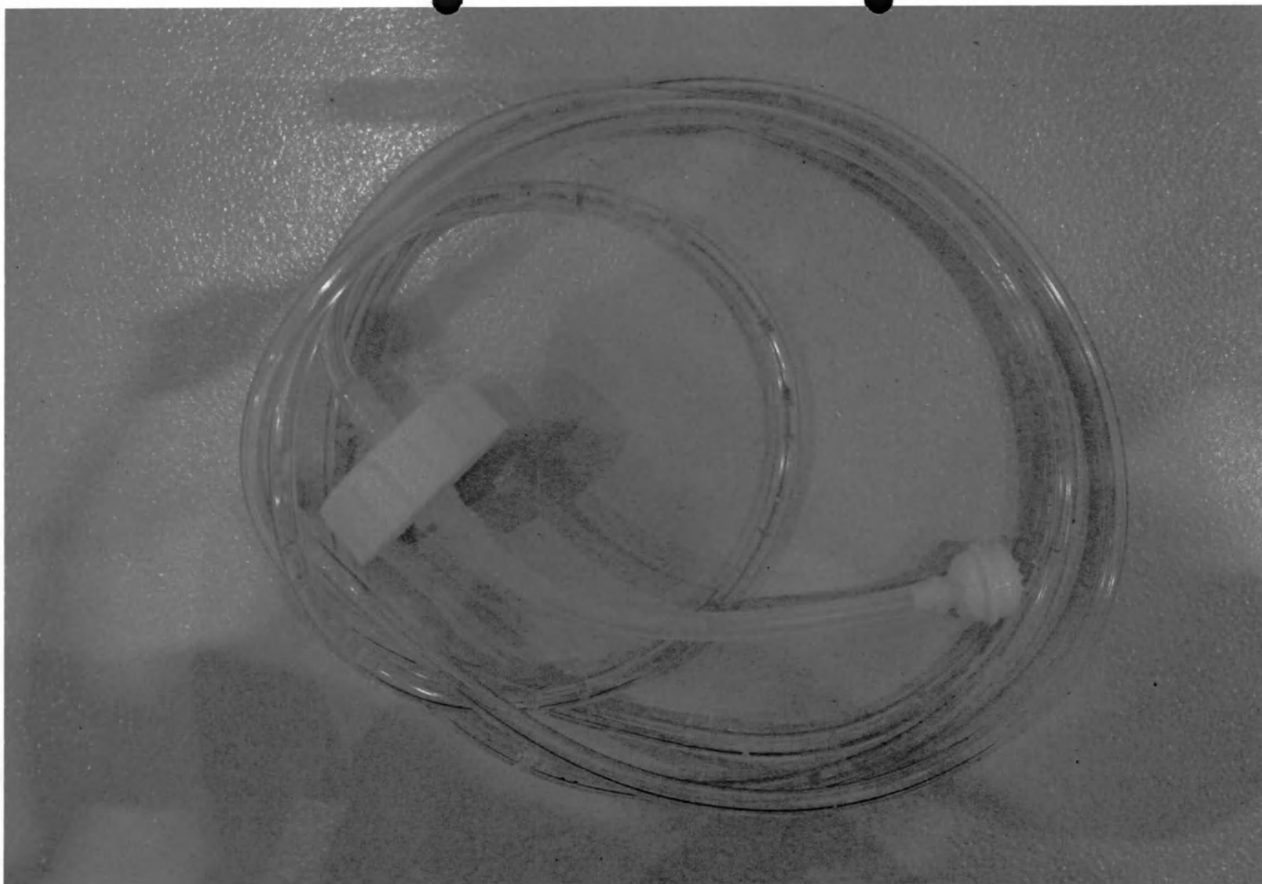
Рисунок 9 – Крышка с трубкой для ёмкости под разбавитель образцов
