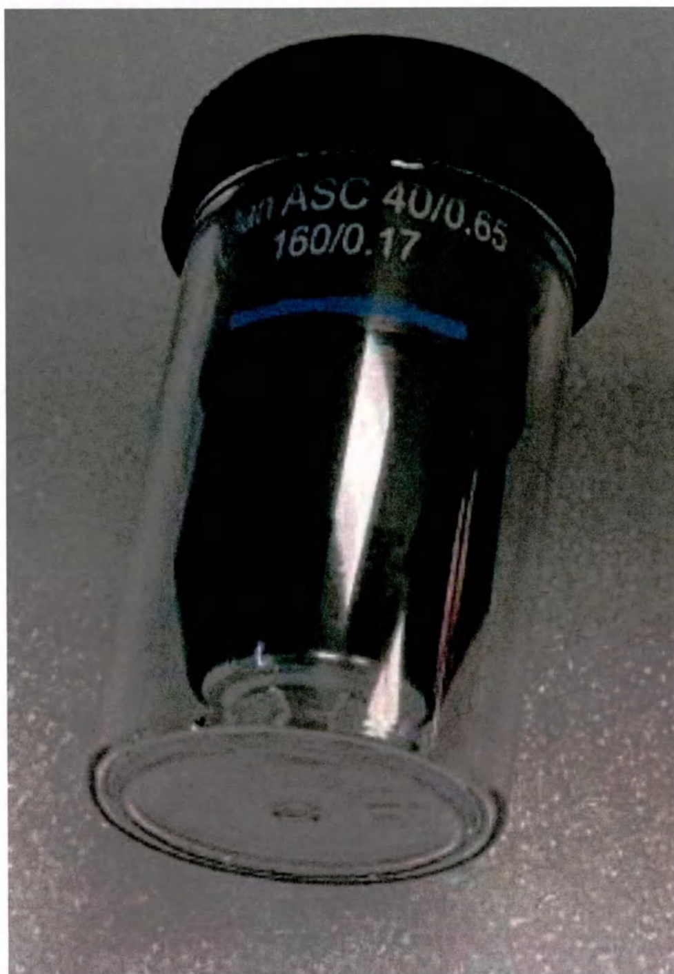
Рисунок 13 – Объектив микроскопа (Plan ASC 40/0.65 160/0.17)
