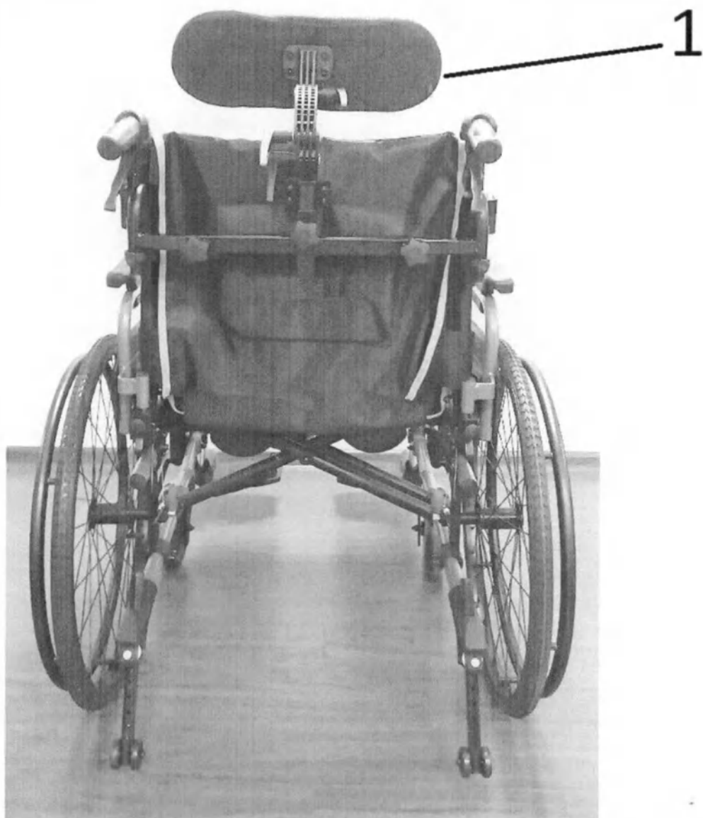
Внешний вид сзади (в сборе) с указанием изменений во внешнем виде, где: 1 – подголовник, закрепленный на каркасе спинки (подголовник внешне не изменился, но ранее крепился на рукоятках).
