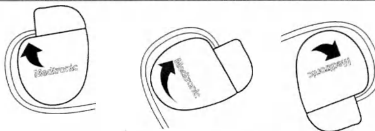
Рисунок 4. Вращение устройства позволяет выбрать излишнюю длину электродов
