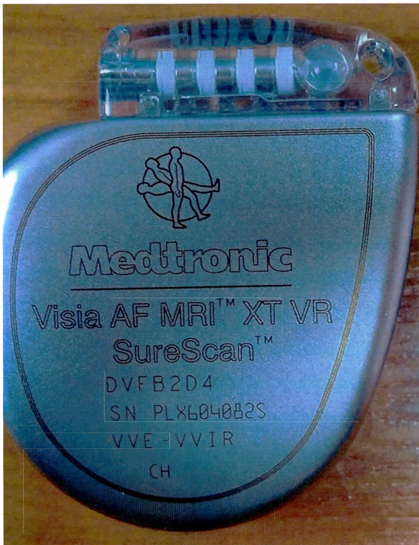
Рисунок 44. Кардиовертер-дефибриллятор имплантируемый однокамерный цифровой Visia, MPT-совместимый Visia AF MRI XT VR с технологией SureScan (VVE-VVIR), модель DVFB2D4 – лицевая сторона.
