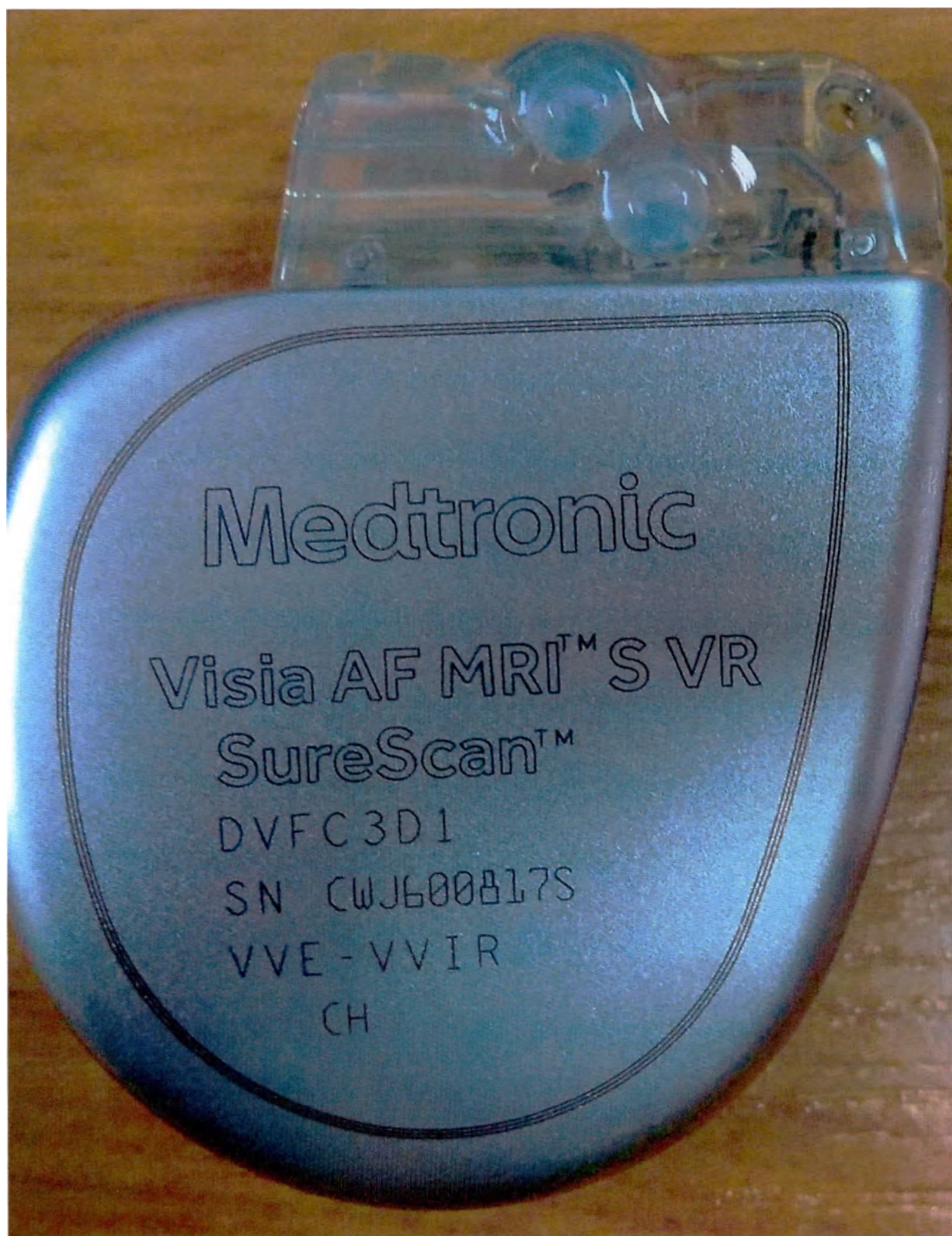
Рисунок 28. Кардиовертер-дефибриллятор имплантируемый однокамерный цифровой Visia, МРТ-совместимый Visia AF MRI S VR с технологией SureScan (VVE-VVIR), модель DVFC3D1 – лицевая сторона.
