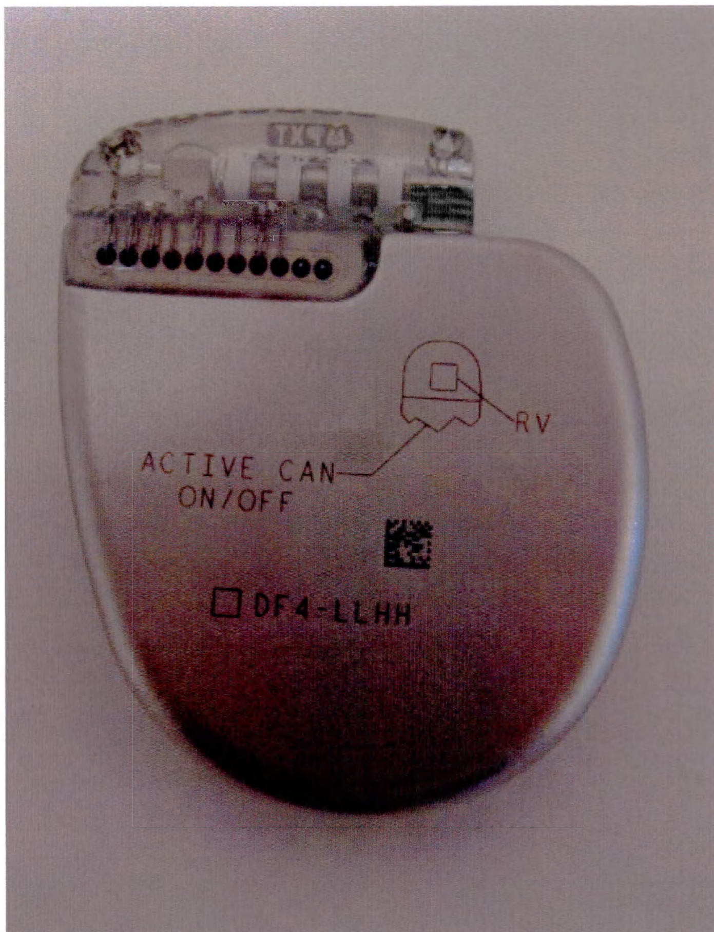
Рисунок 34. Кардиовертер-дефибриллятор имплантируемый однокамерный цифровой Visia, MPT-совместимый Visia AF MRI S VR с технологией SureScan (VVE-VVIR), модель DVFC3D4 – задняя сторона.
