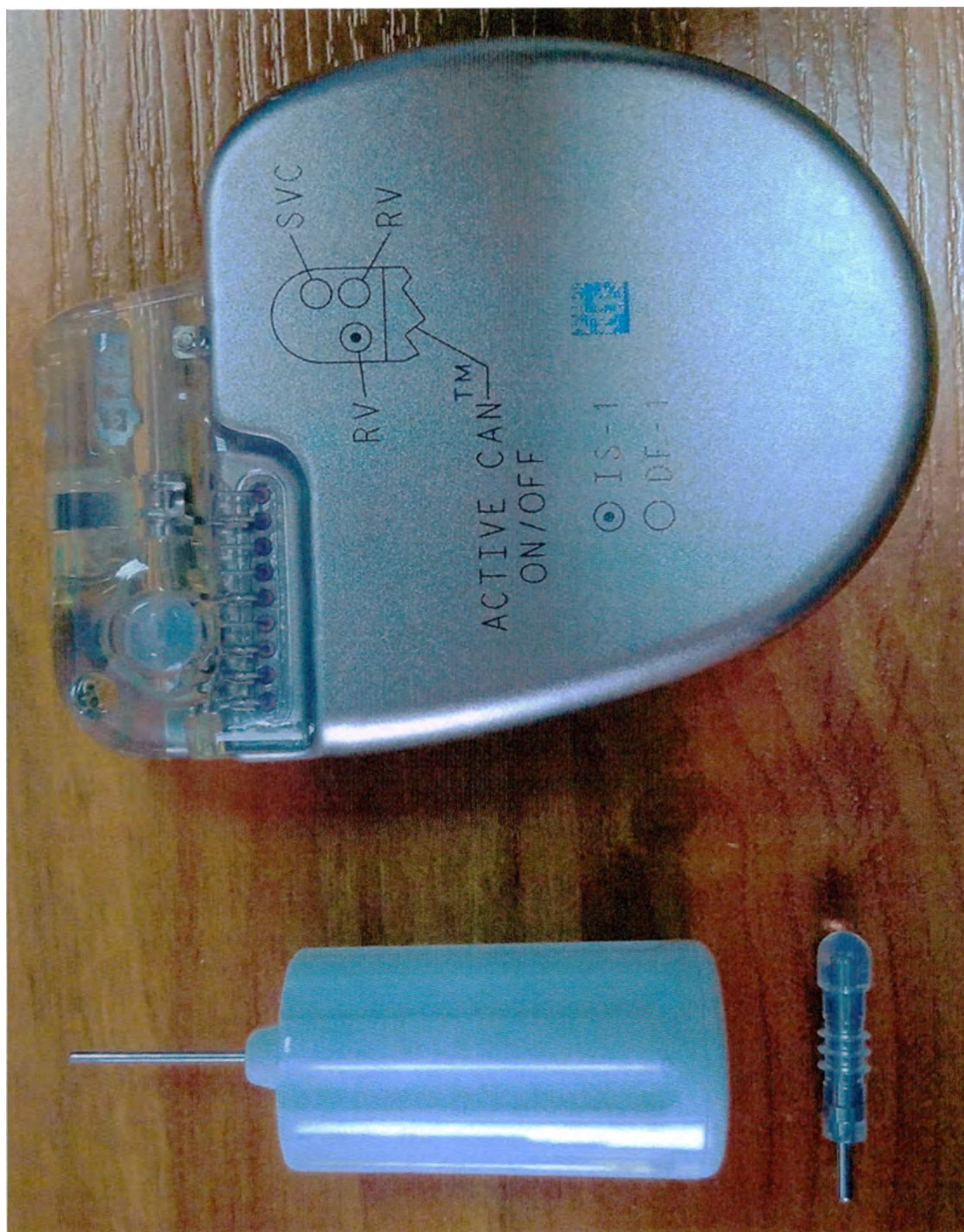
Рисунок 29. Кардиовертер-дефибриллятор имплантируемый однокамерный цифровой Visia, МРТ-совместимый Visia AF MRI S VR с технологией SureScan (VVE-VVIR), модель DVFC3D1 – задняя сторона, ключ с тарированным усилием, заглушка коннекторной части DF-1.
