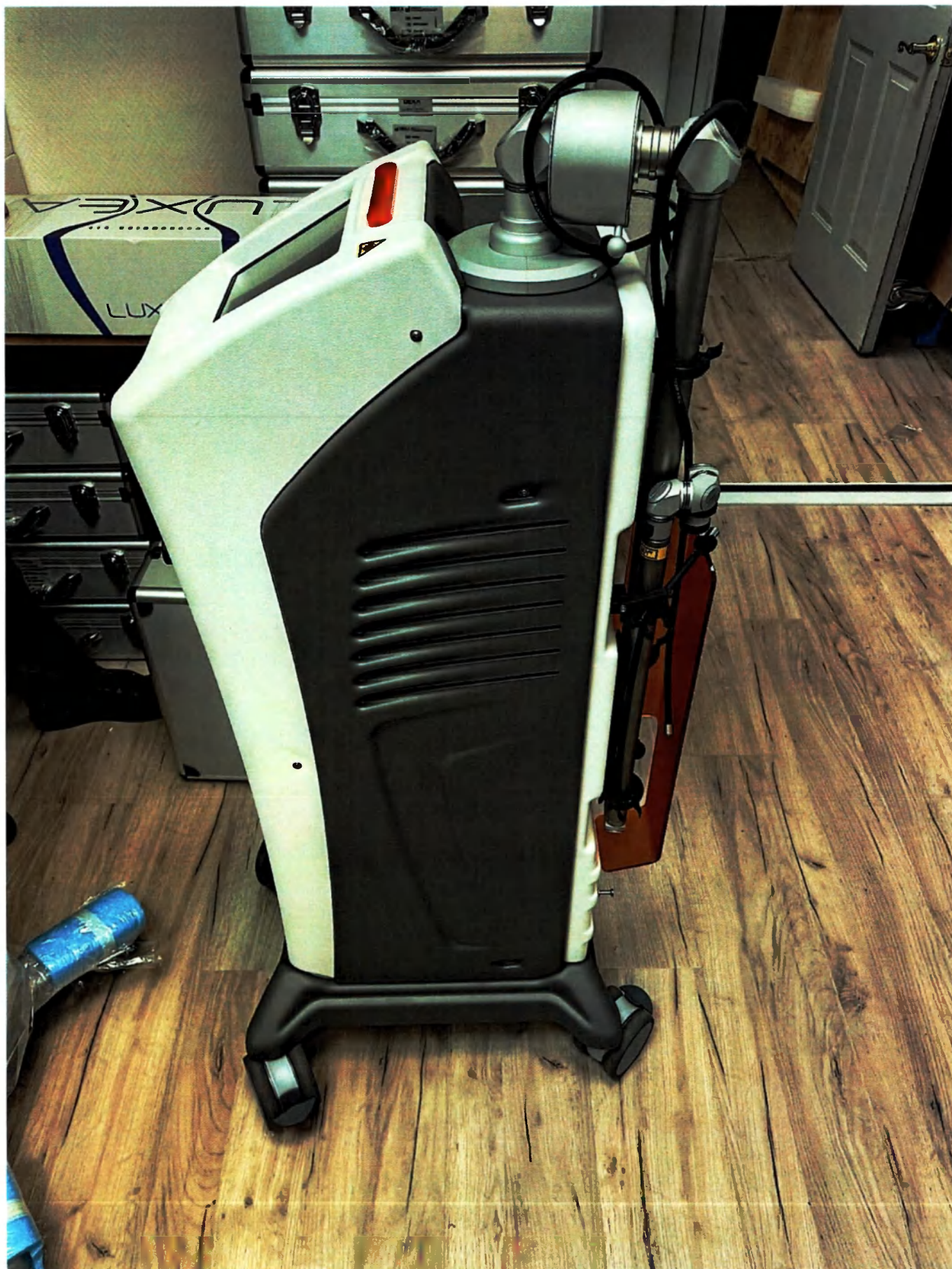
Фото 9 - Шарнирный рычаг с трубкой обдува в сложенном виде
