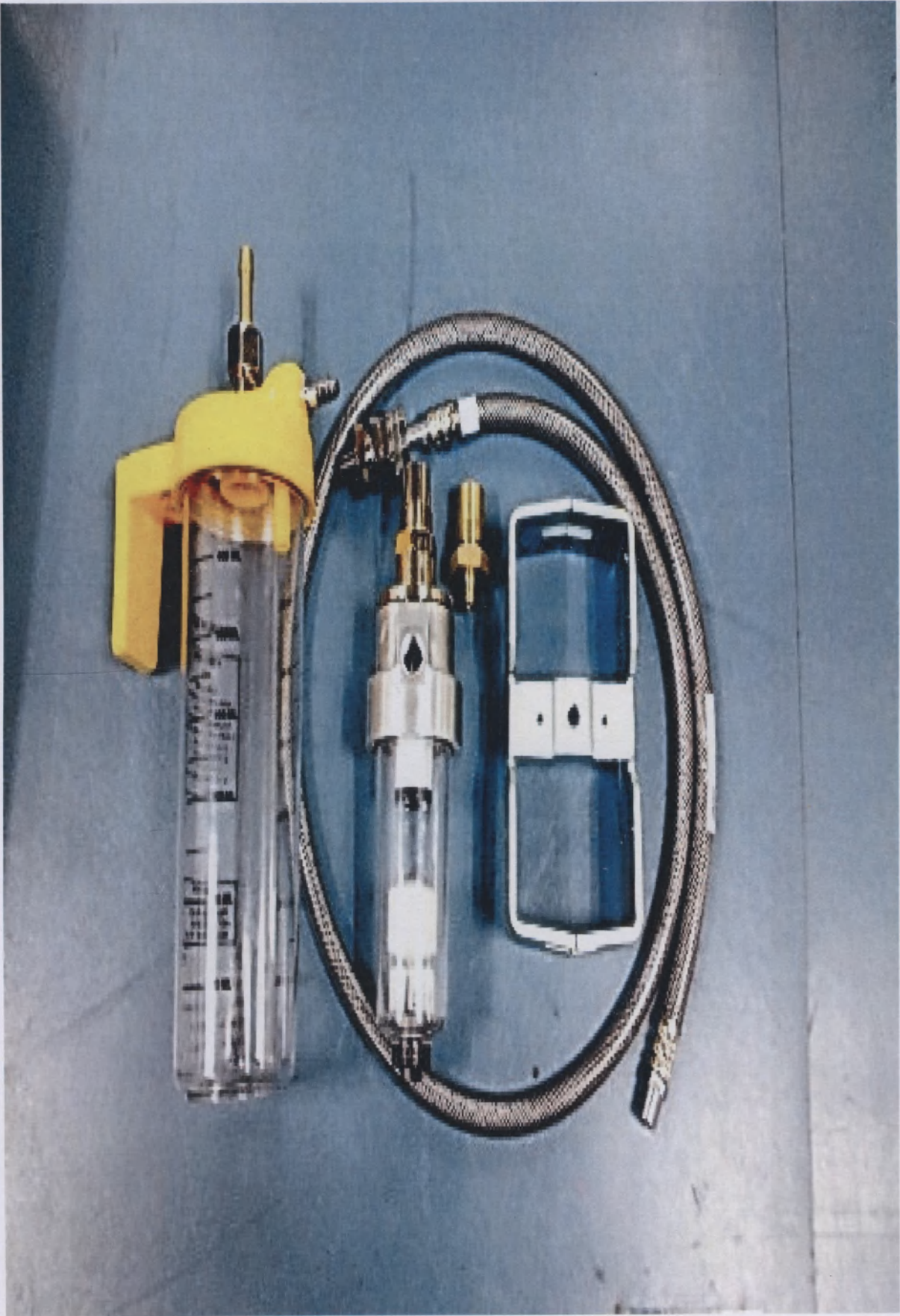
135. Ловушка водяная для компрессора.
