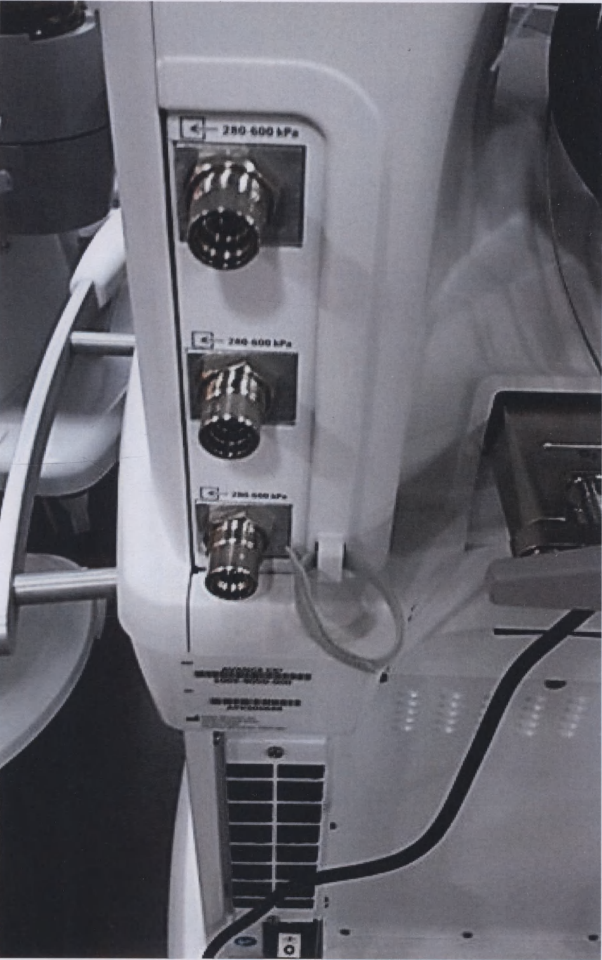
132. Разъём для воздуха.
