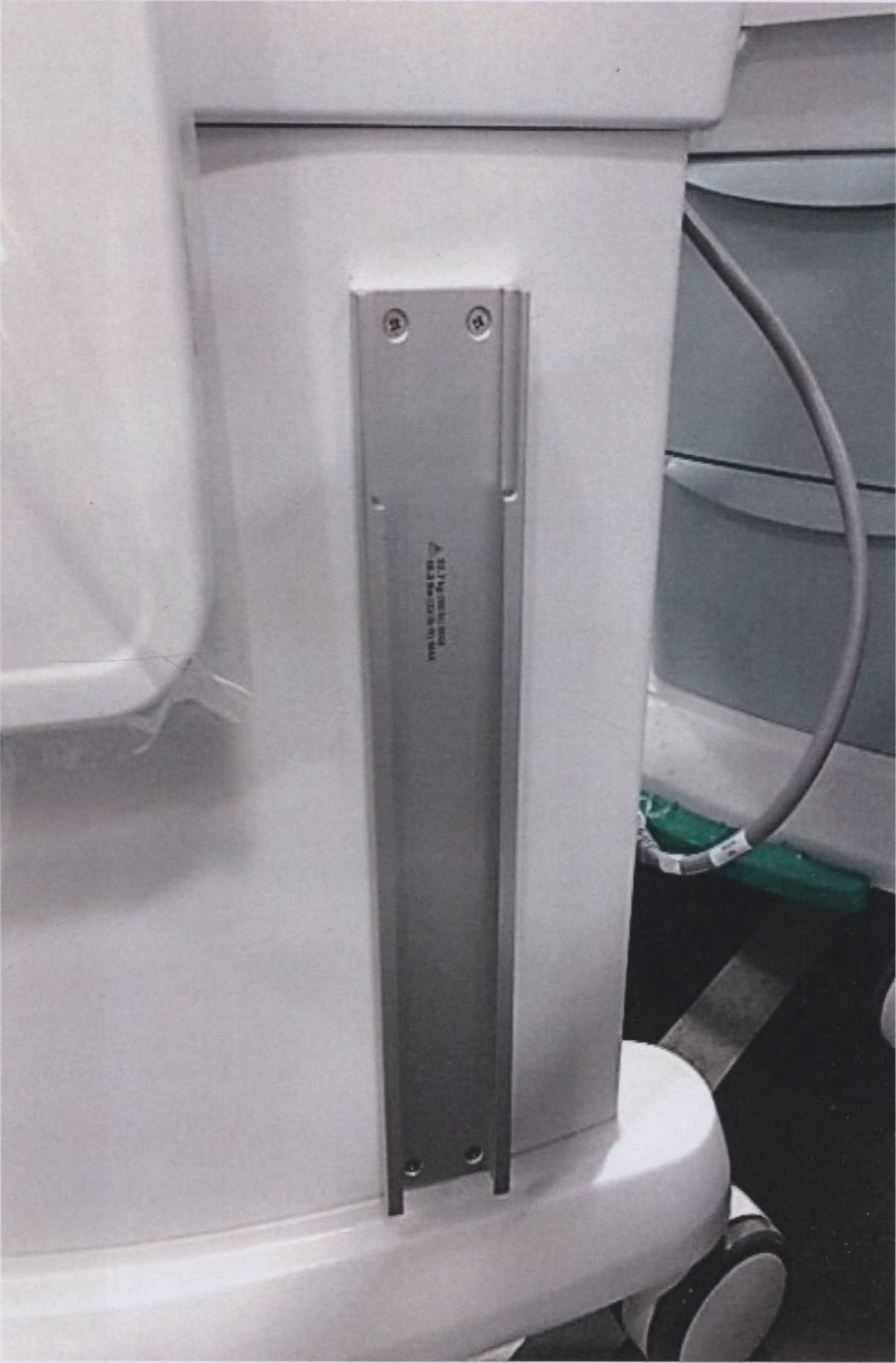
97. Крепление GCX на тележке.
