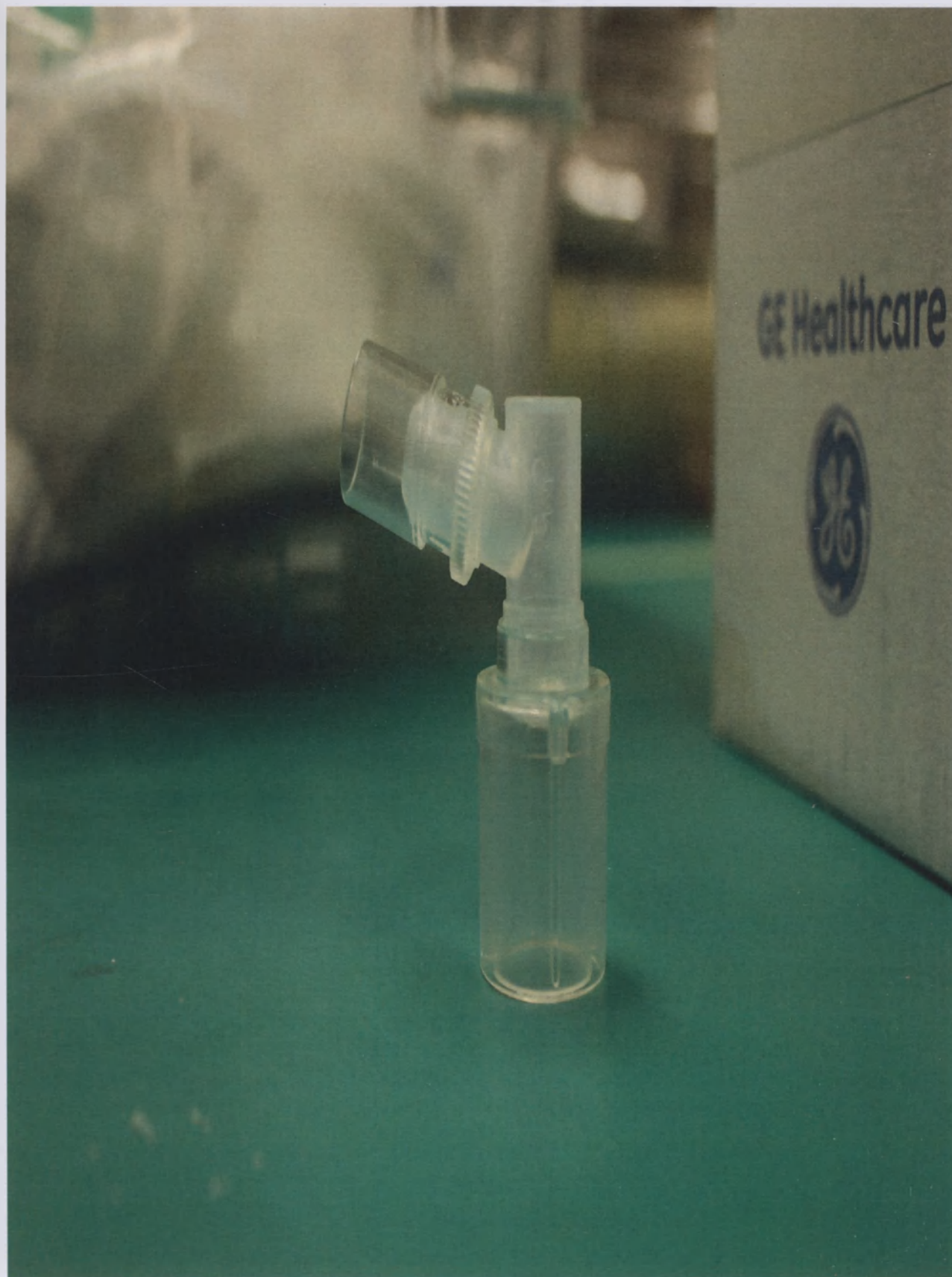
116. Переходники для подсоединения дыхательного мешка
