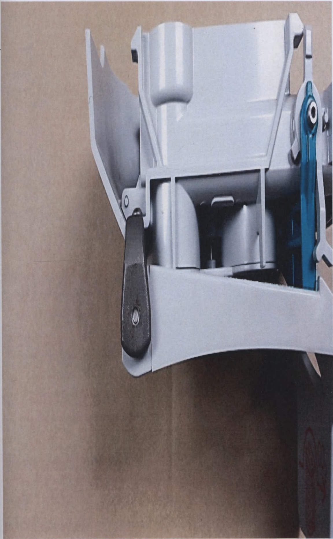
55. Крепление канистры абсорбера EZchange.
