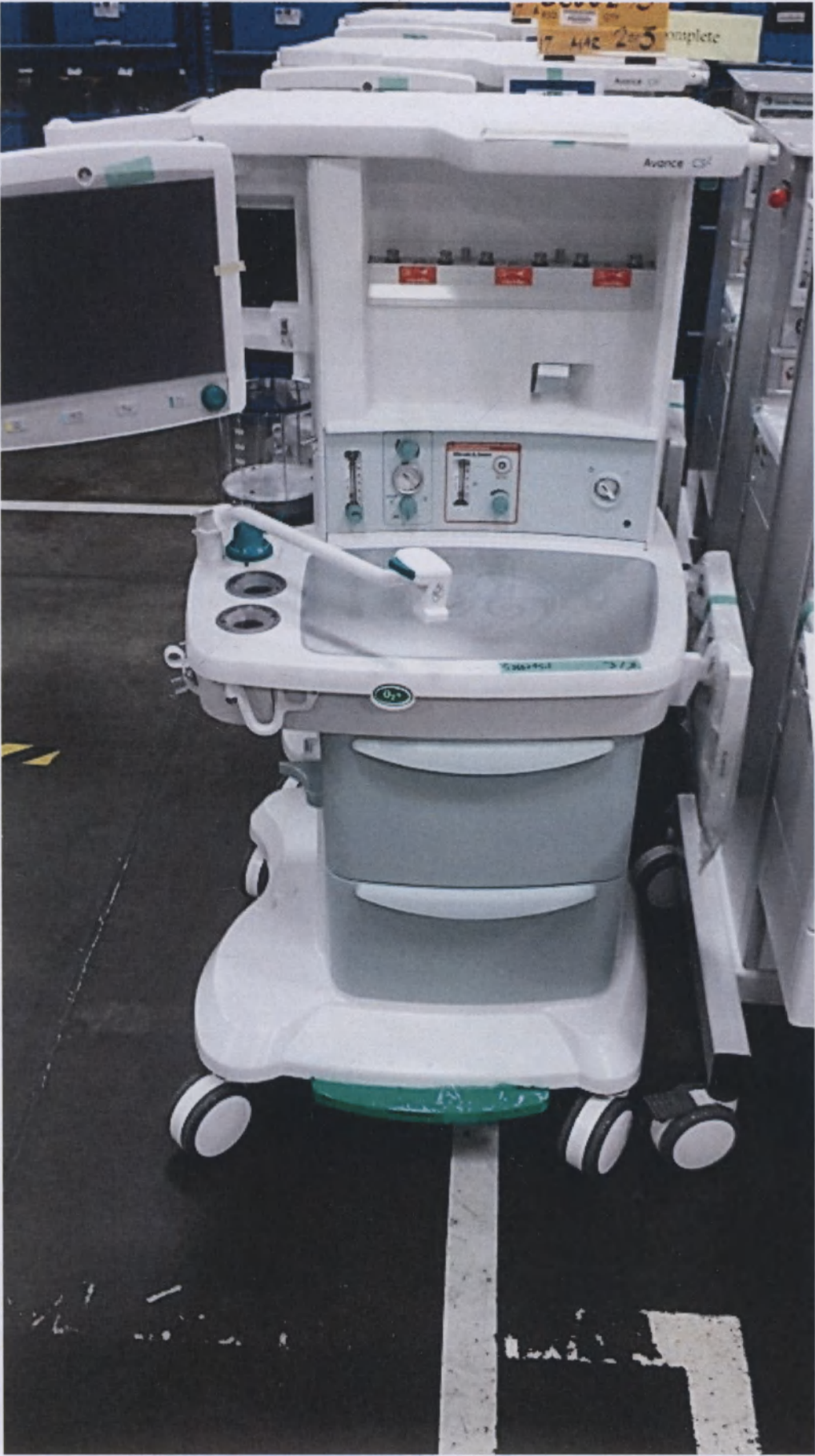
16. Тележка с креплением под 3 испарителя.
