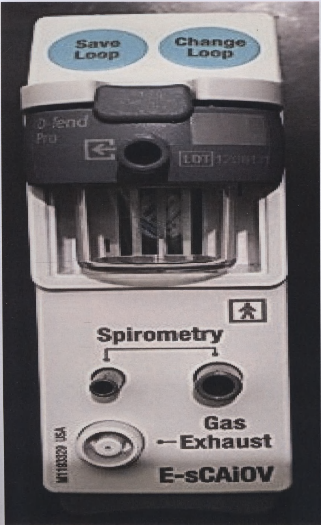
46. Модуль газовый E-sCAiOV.
