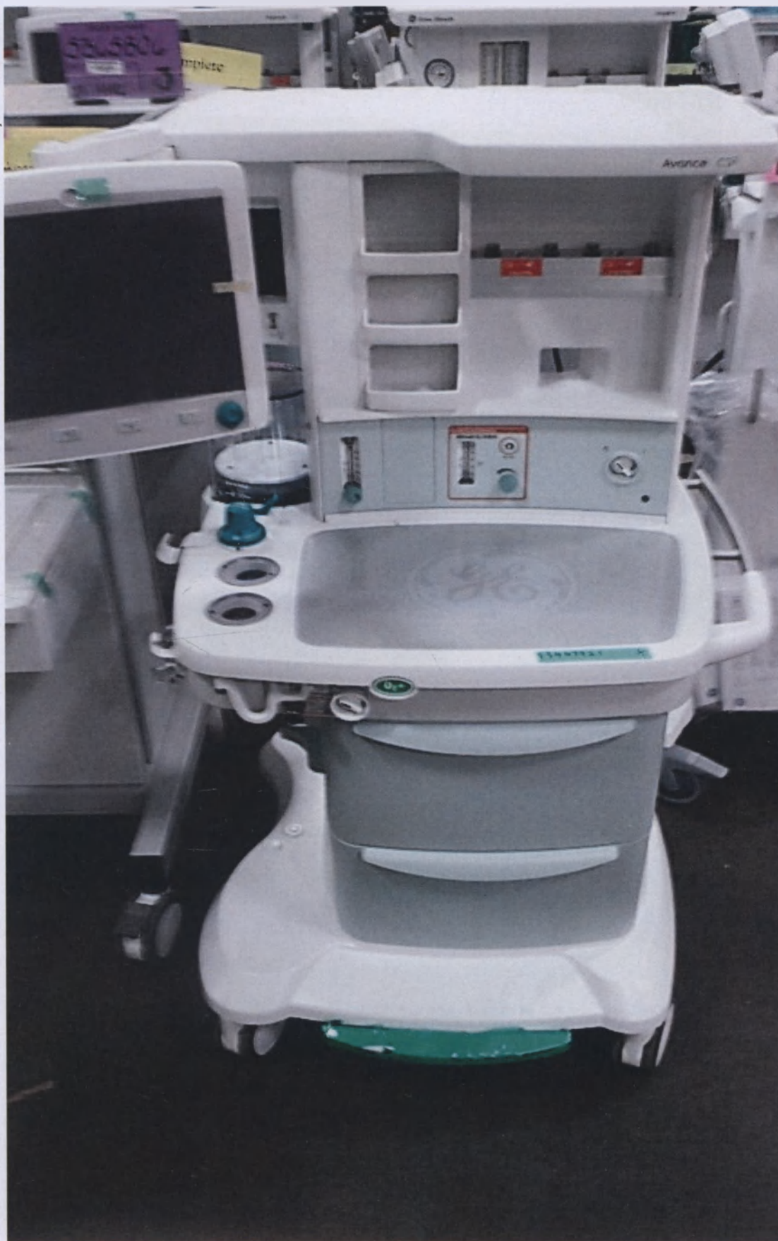
15. Тележка с креплением под 2 испарителя.
