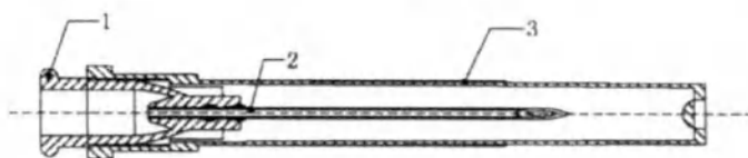
1 - канюля иглы; 2 - трубчатая металлическая часть иглы; 3 - защитный колпачок. Рис. 9 Игла инъекционная однократного применения стандартная. «Луер Слип»
