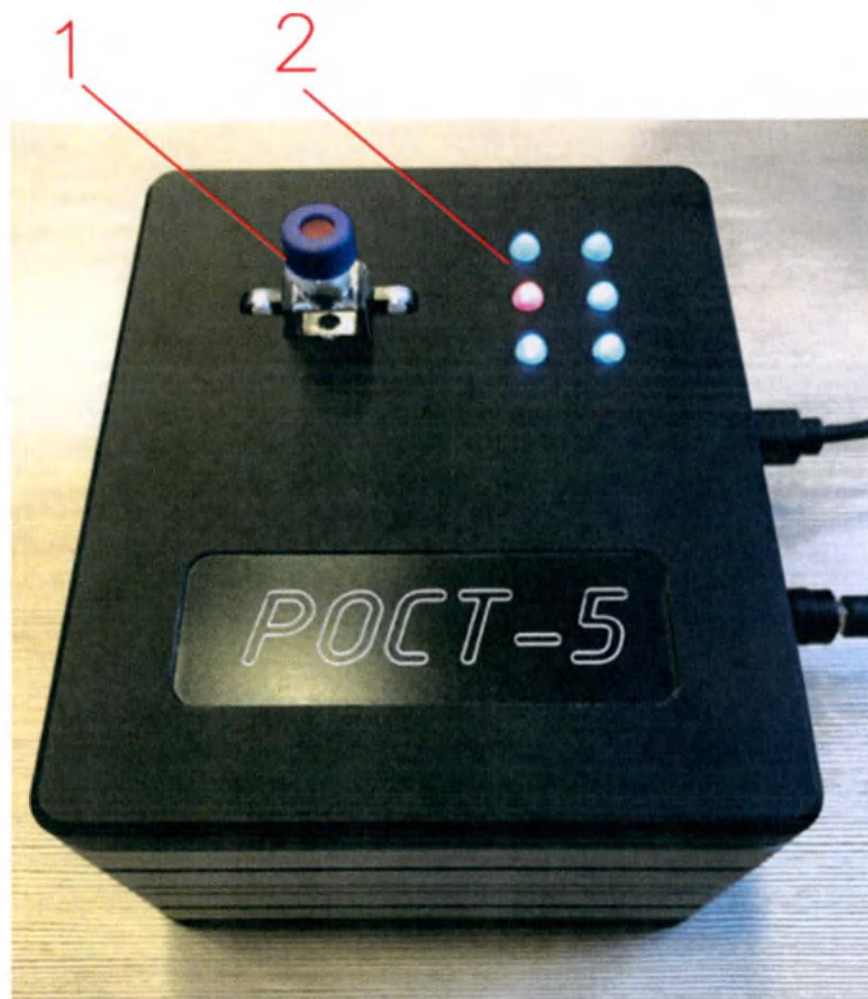
Рисунок 8 – Способ установки картриджа в прибор
