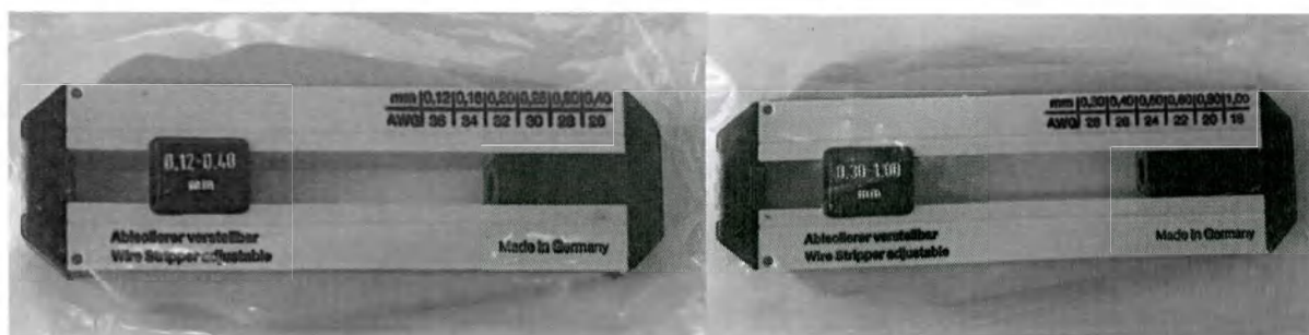
Рисунок 10- Стриппер волоконного инструмента от 0,12 до 0,4 мм (а) и Стриппер волоконного инструмента от 0,3 до 1 мм (б)
