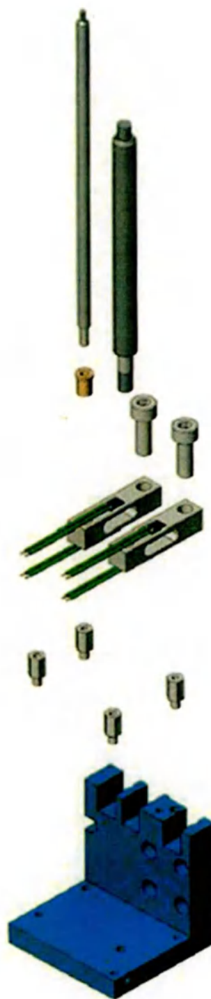
Компоновка подъёмника поршня
