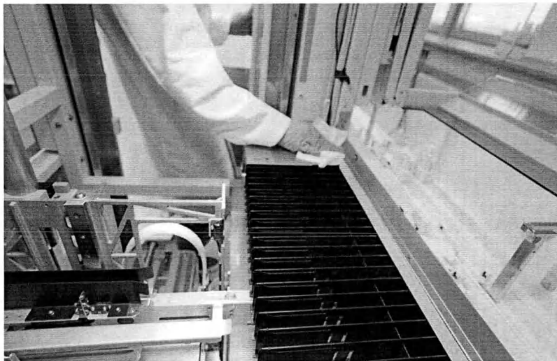
Рисунок 5.205 Очистка кожуха области накопления штативов
