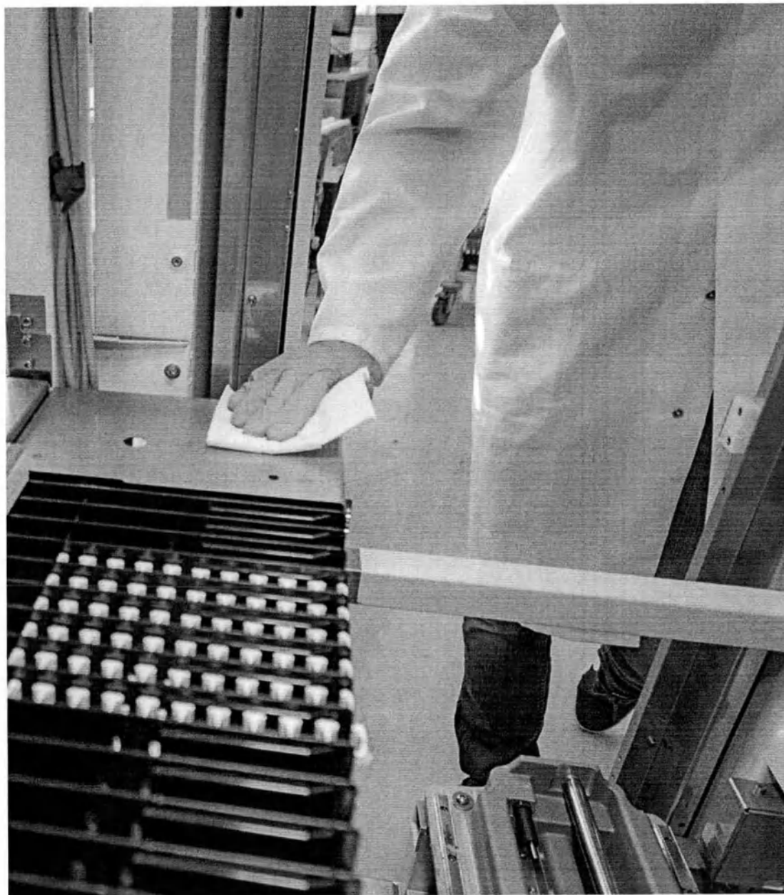
Рисунок 5.202 Очистка кожуха области накопления штативов
