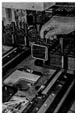
Рисунок 1.45 Адаптер центрифуги с гладкой стороной, направленной влево к челноку для адаптера
