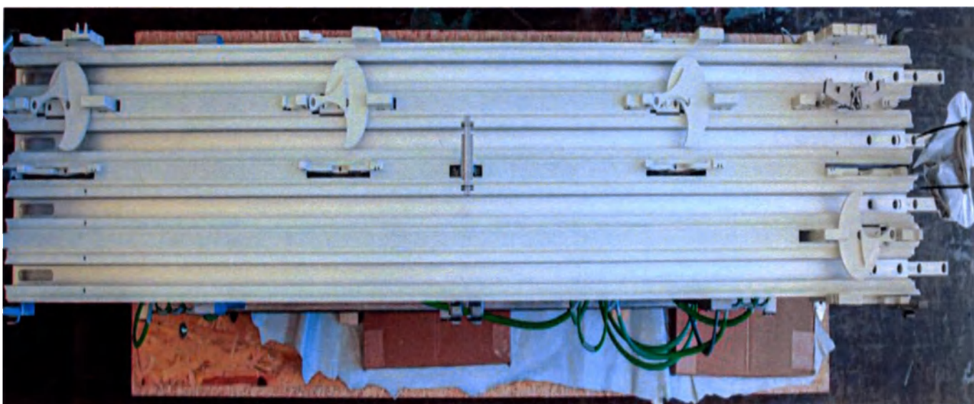
Транспортная линия с направляющим механизмом, 938 мм
