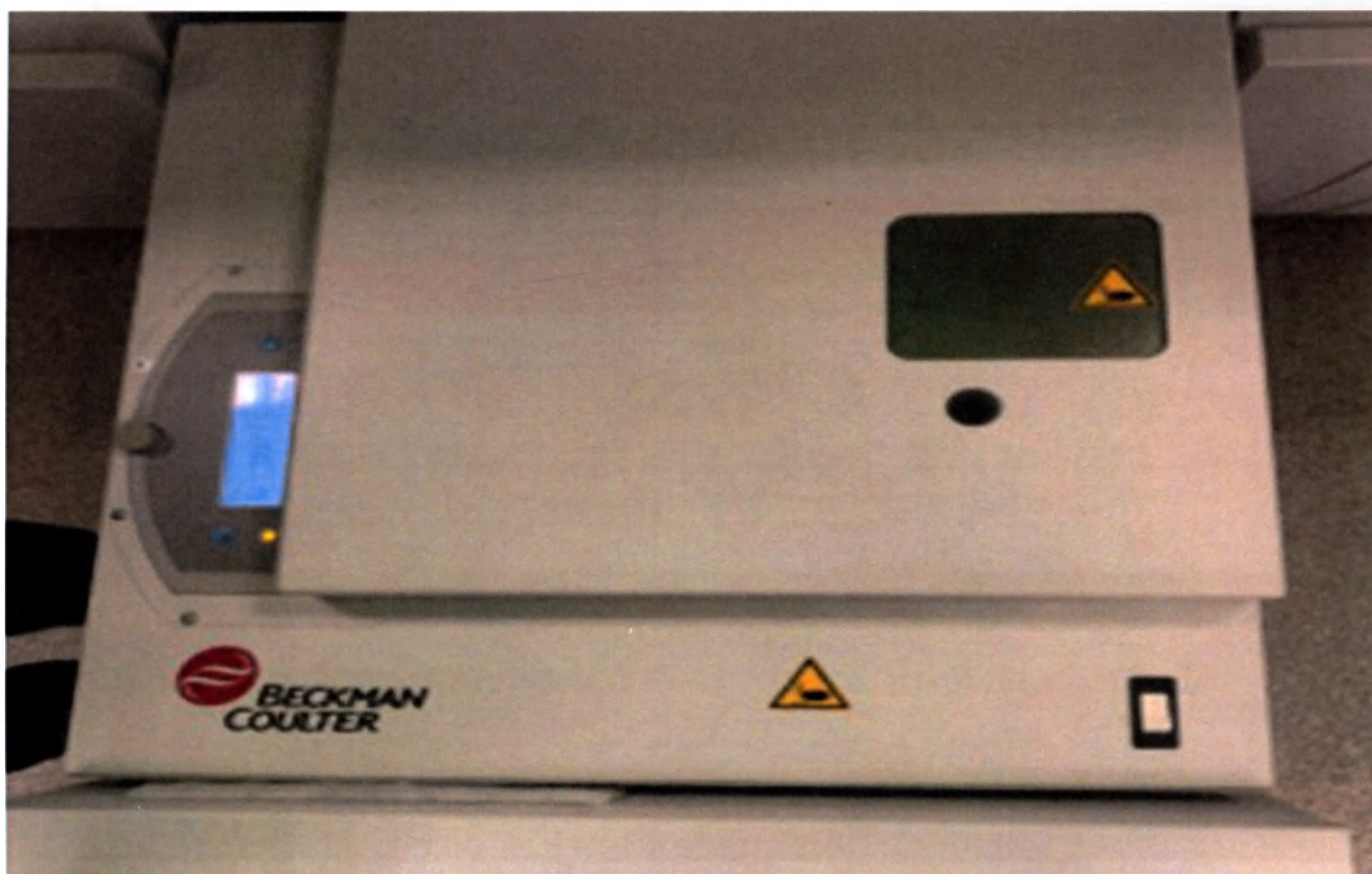
Модуль центрифугирования с двумя центрифугами (DxA Automation System Dual Centrifuge)
