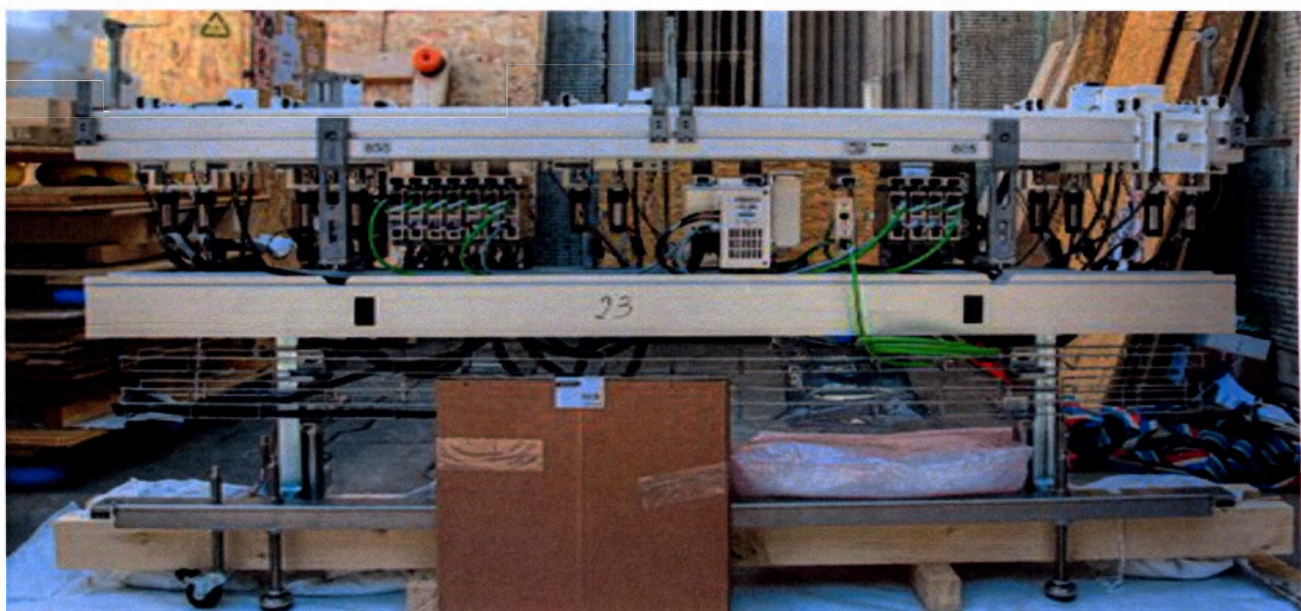
Транспортная линия с двумя разворотными механизмами, 1250 мм
