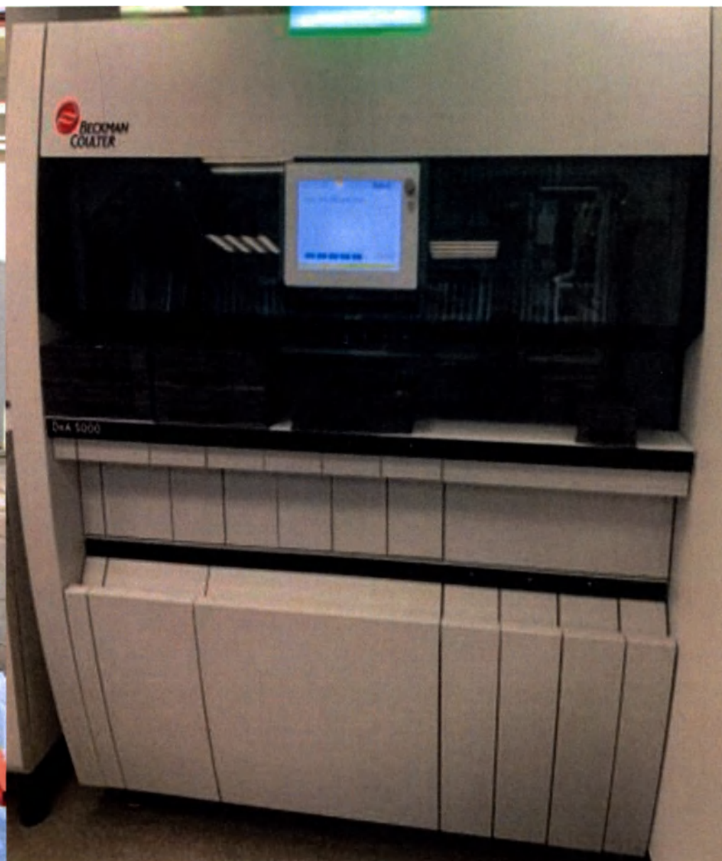
Модуль выгрузки с устройством закрывания пробирок (DxH Automation System Output Rescaper)
