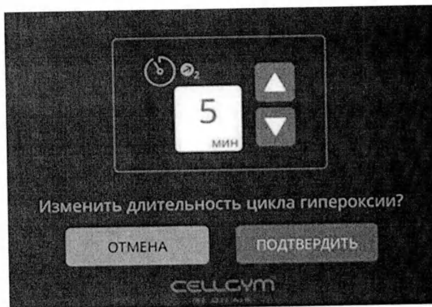
Рисунок 58 – Экран настройки длительности цикла гипероксии
