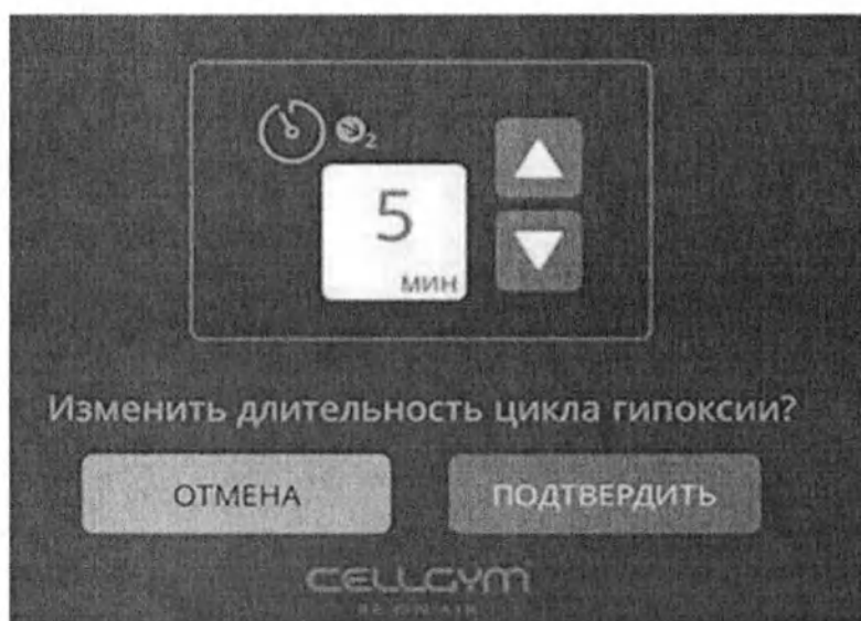
Рисунок 41 – Экран регулировки длительности цикла гипоксии
