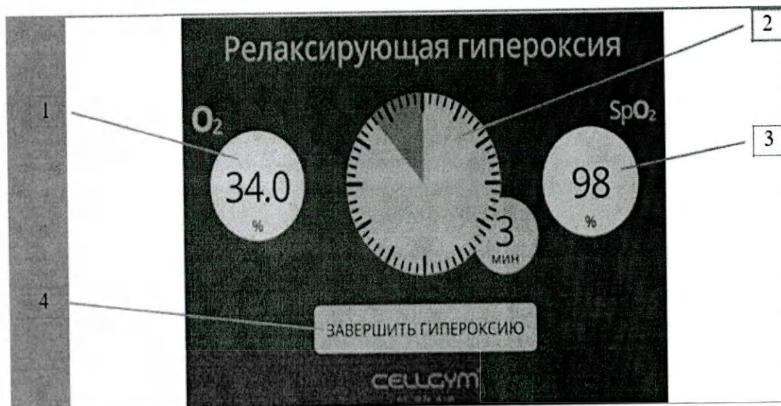
Рисунок 62 – Экран релаксирующей гипероксии: 1- индикатор содержания O_2 в дыхательной смеси; 2- изображение таймера, указывающего оставшееся время гипероксии; 3 – индикатор SpO_2 ; 4– кнопка прерывания гипероксии.
