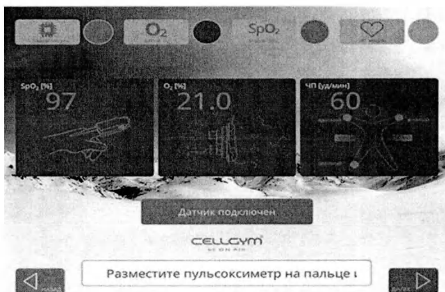
Рисунок 18 – Экран ошибки при неправильном подключении канала O_2
