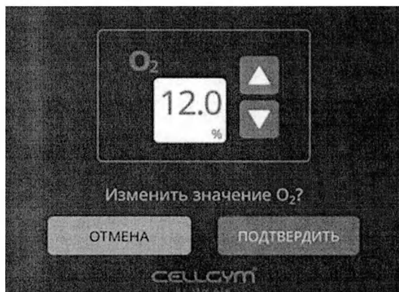
Рисунок 42 – Экран регулировки содержания O_2 в ДС
