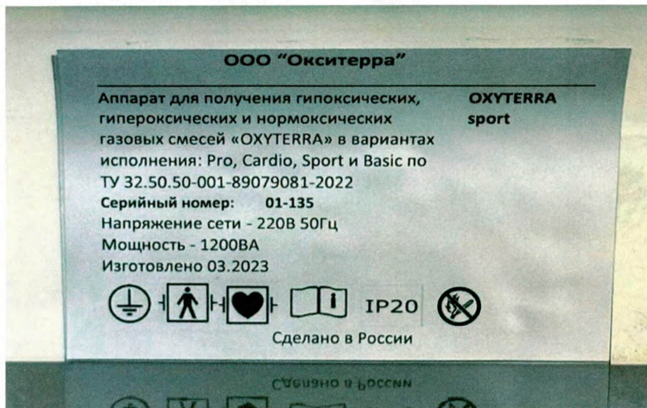
Рис. 40. Шильдик Аппарата для получения гипоксических, гипероксических и нормоксических газовых смесей «Oxyterra» вариант исполнения Sport.
