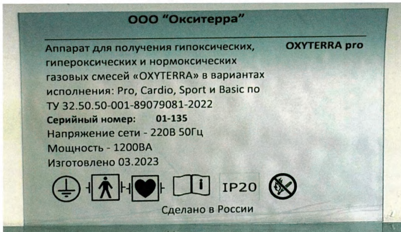
Рис. 5. Шильдик Аппарата для получения гипоксических, гипероксических и нормоксических газовых смесей «Oxyterra» вариант исполнения PRO.
