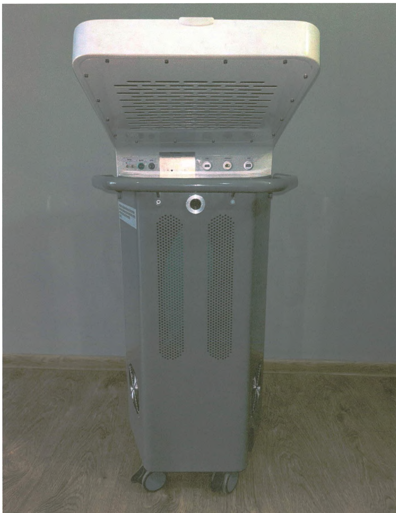
Рис. 3. Аппарат для получения гипоксических, гипероксических и нормоксических газовых смесей «Охулетта» вариант исполнения PRO. Вид сзади.
