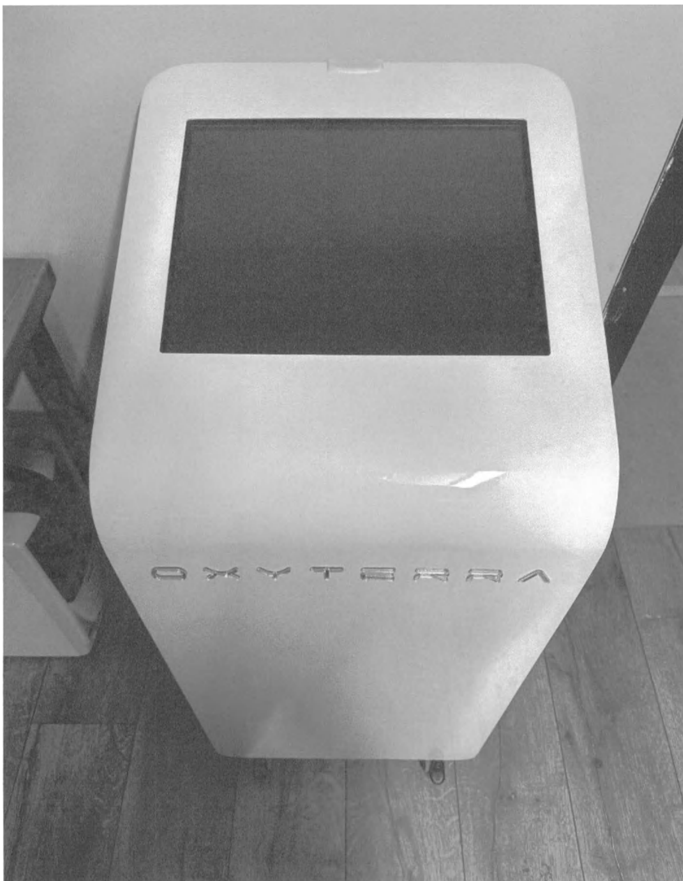
Рис. 39. Аппарат для получения гипоксических, гипероксических и нормоксических газовых смесей «Охутерра» вариант исполнения Sport. Вид сверху.
