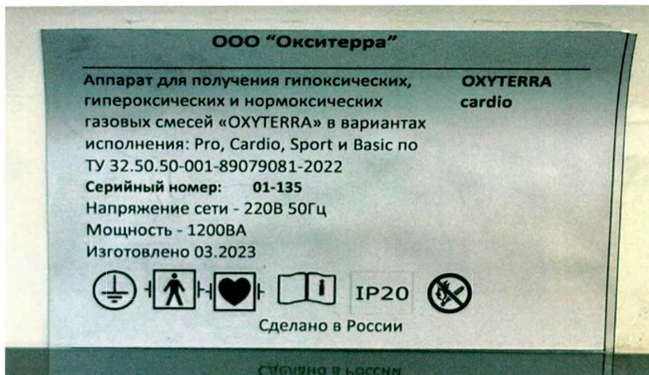
Рис. 23. Шильдик Аппарата для получения гипоксических, гипероксических и нормоксических газовых смесей «Oxyterra» вариант исполнения Cardio.
