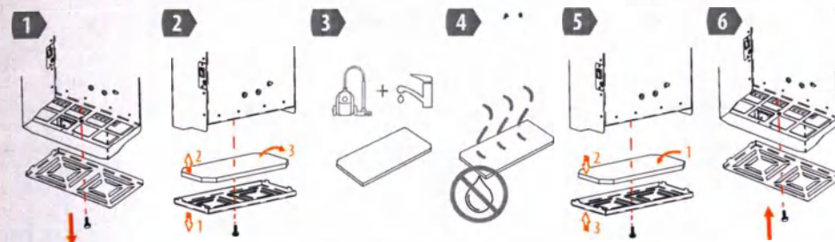
Рисунок 16. Операции при очистке воздушного фильтра групп исполнений OBU-315, OBU-515, OBU-230, OBU-330, OBU-430
