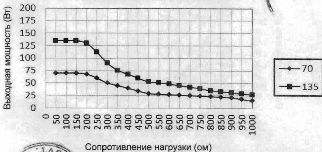
Рисунок 144 – График зависимости выходной мощности от сопротивления нагрузки в режиме работы радиочастотным скальпелем «Sharp Cut»
