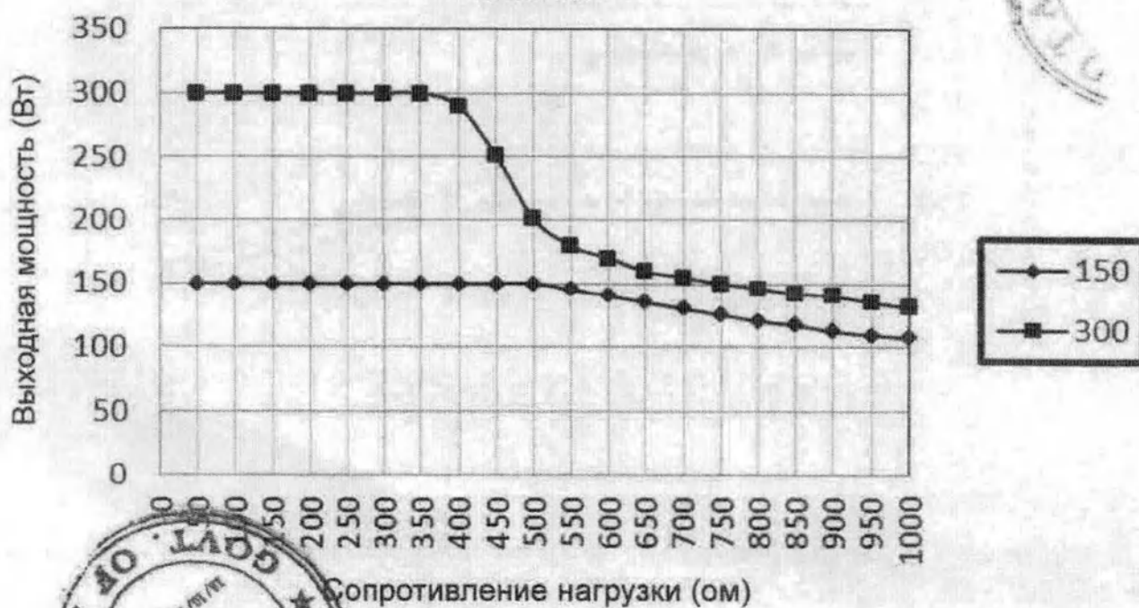
Рисунок 140 – График зависимости выходной мощности от сопротивления нагрузки в режиме резания в физиологическом растворе «Cut-III»
