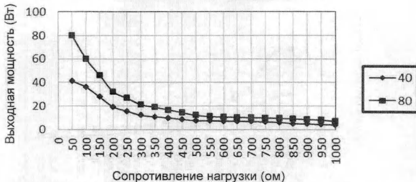
Рисунок 147 – График зависимости выходной мощности от сопротивления нагрузки в режиме работы радиочастотным скальпелем «Smart Coag»
