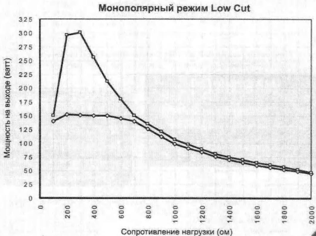
Рисунок 111 – График зависимости выходной мощности от сопротивления нагрузки в монополярном режиме Low Cut
