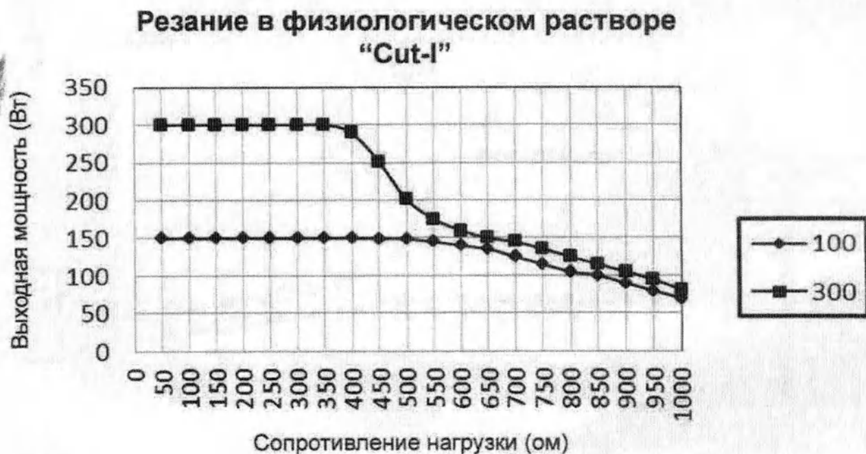
Рисунок 138 – График зависимости выходной мощности от сопротивления нагрузки в режиме резания в физиологическом растворе «Cut-I»
