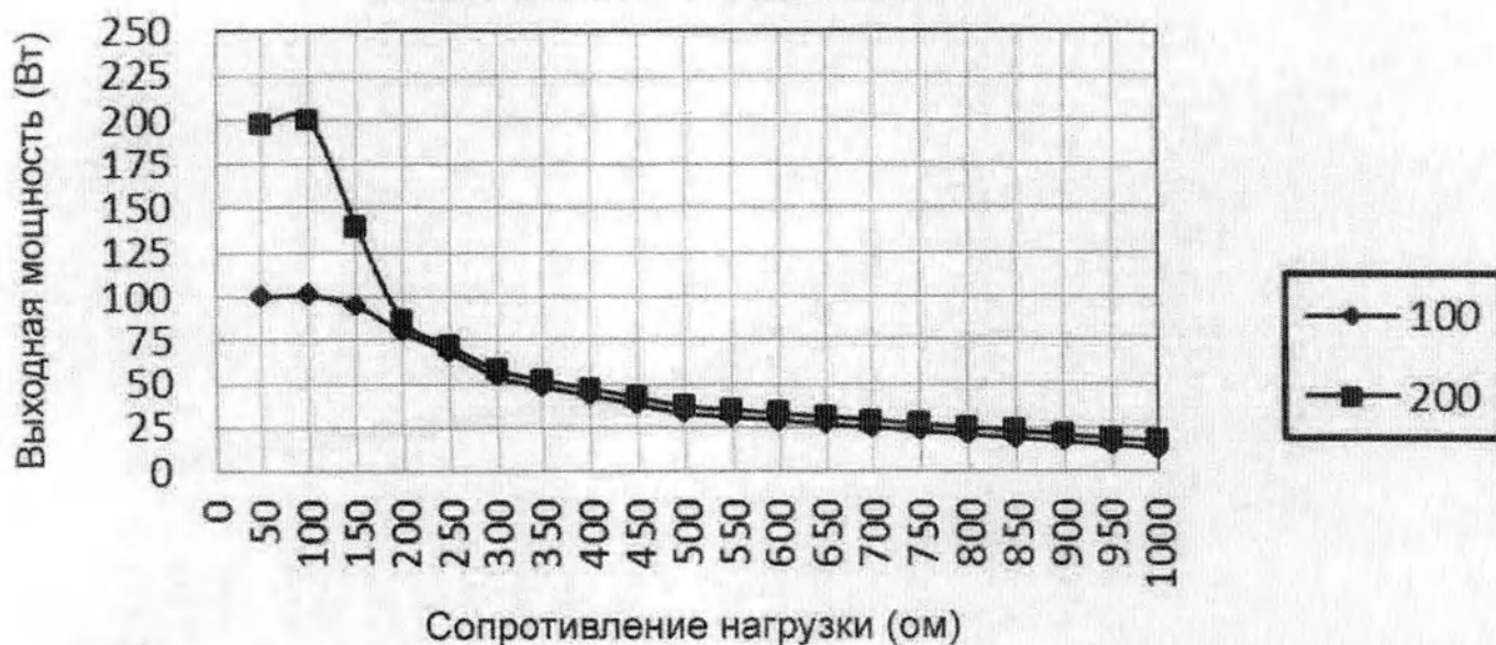
Рисунок 141 – График зависимости выходной мощности от сопротивления нагрузки в режиме коагуляции в физиологическом растворе «Coag-Soft»
