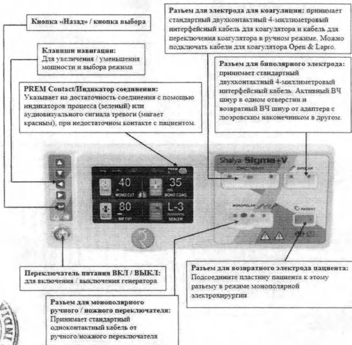
Рисунок 1 – Внешний вид передней панели SHALYA SIGMA+V
