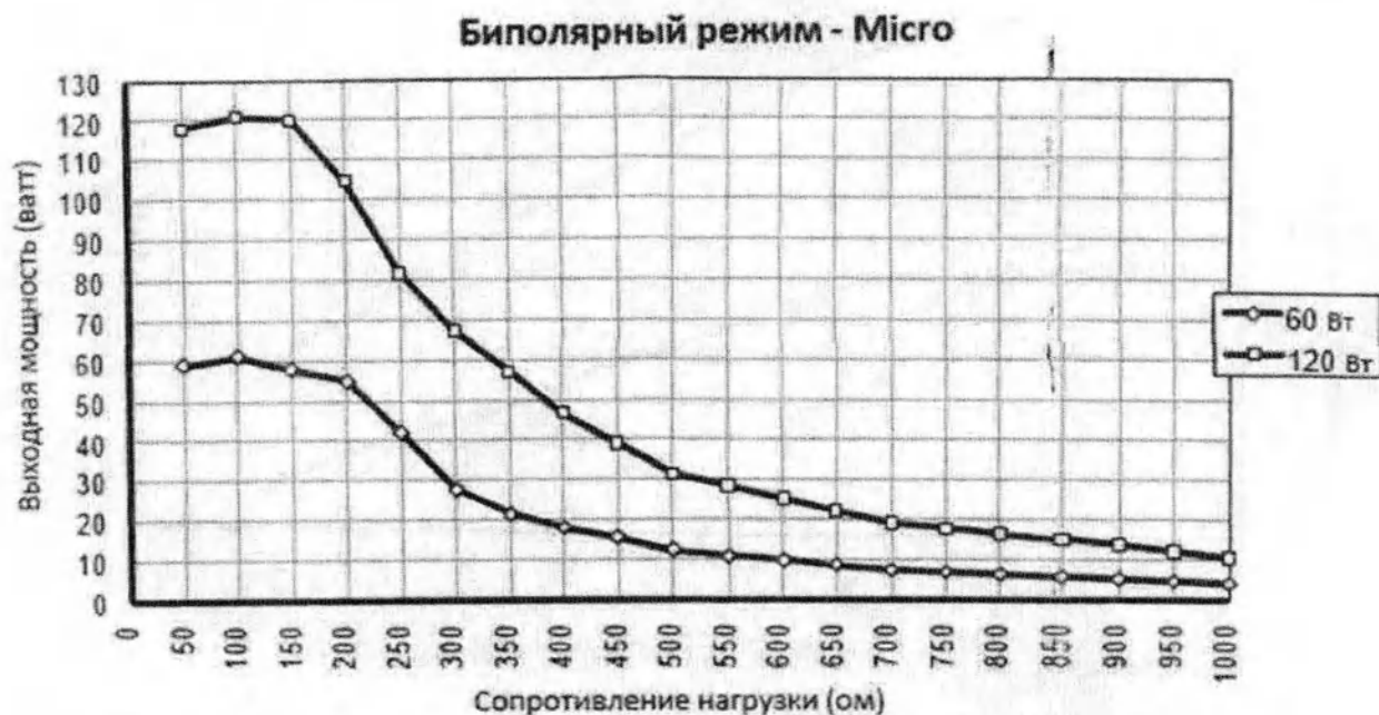
Рисунок 123 - График зависимости выходной мощности от сопротивления нагрузки в Биполярном режиме - Micro
