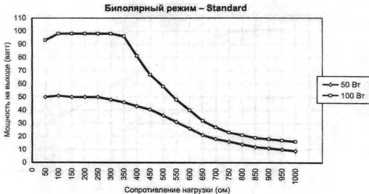
Рисунок 119 – График зависимости выходной мощности от сопротивления нагрузки в биполярном режиме Standard
