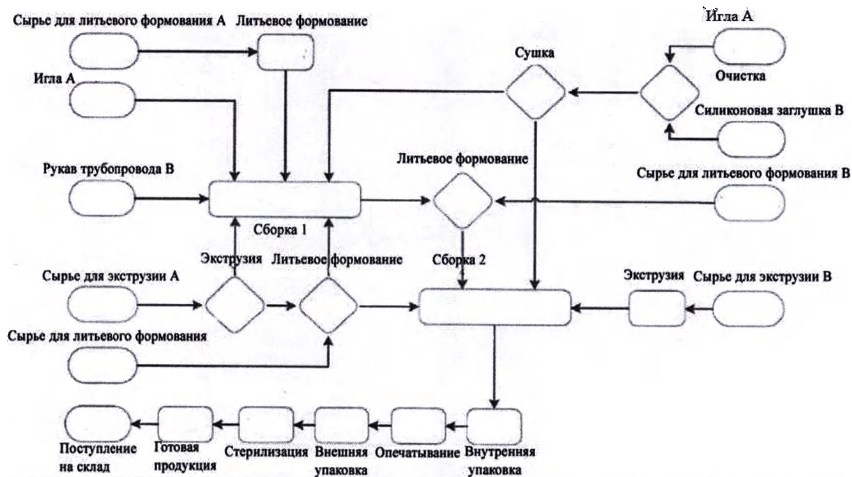
Схема 2 – Основные стадии производства Иглы аспирационной одноразовой стерильной, двухпросветной
