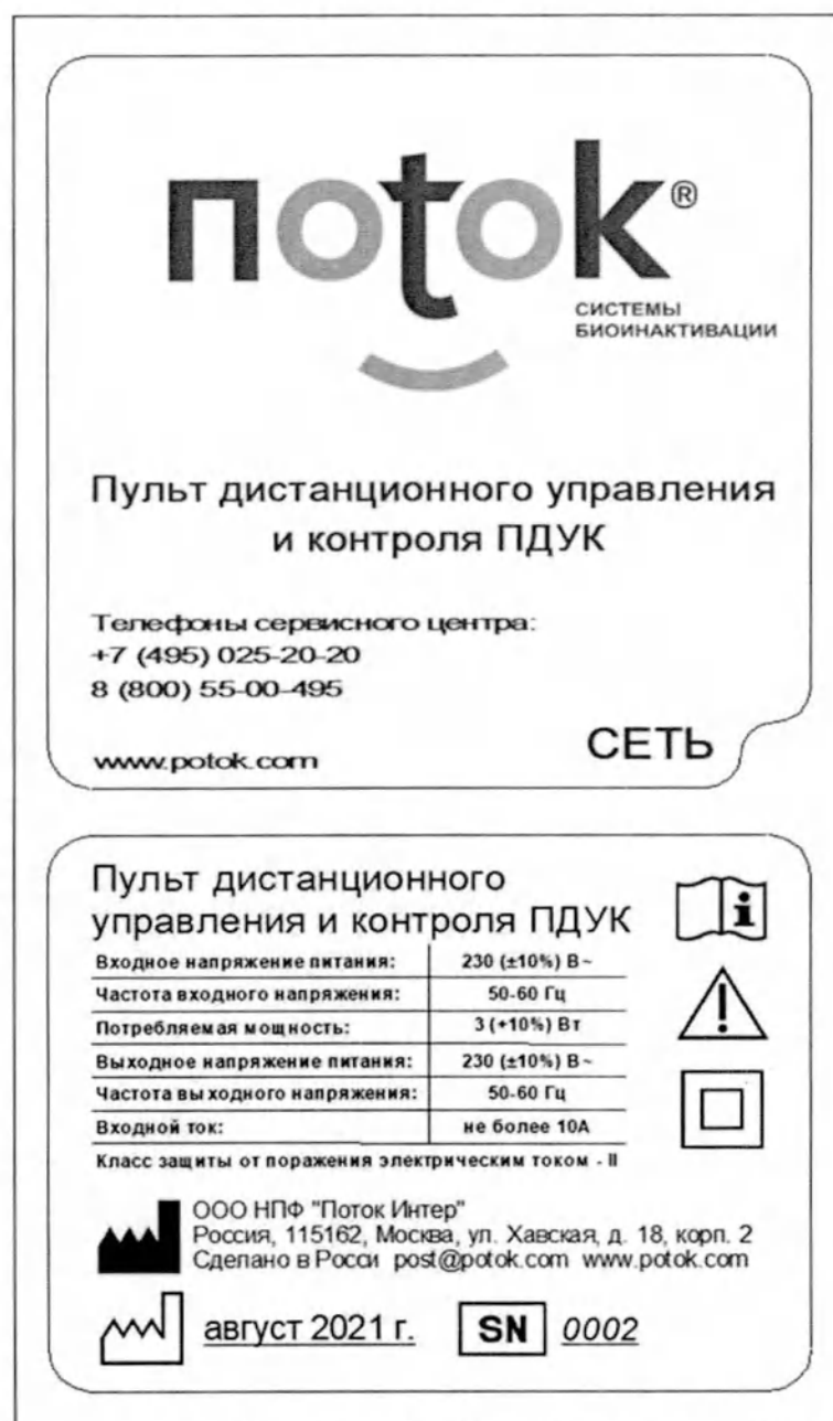
Рис. 15 Внешний вид наклейки-шильдика на Пульте дистанционного управления и контроля ПДУК.
