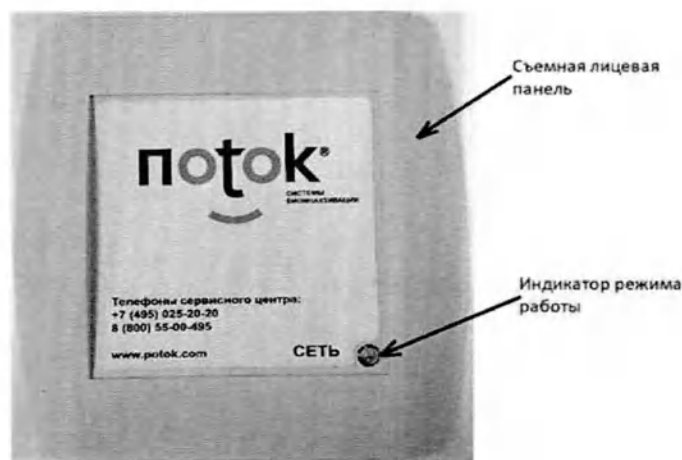
Рис. 3. Внешний вид пульта дистанционного управления и контроля ПДУК.
