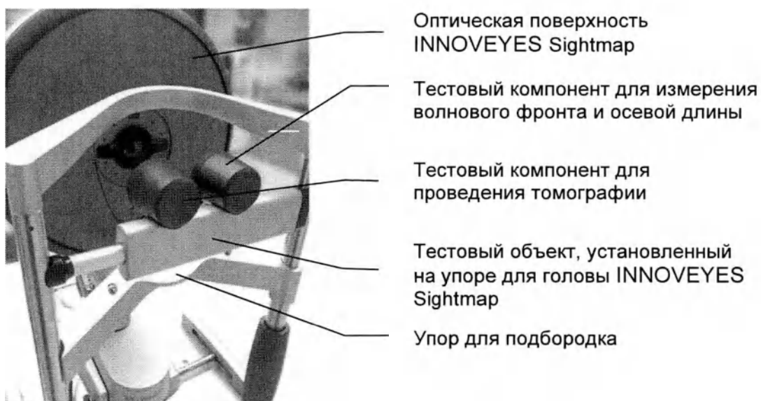
Рисунок 38. Установленный тестовый объект
