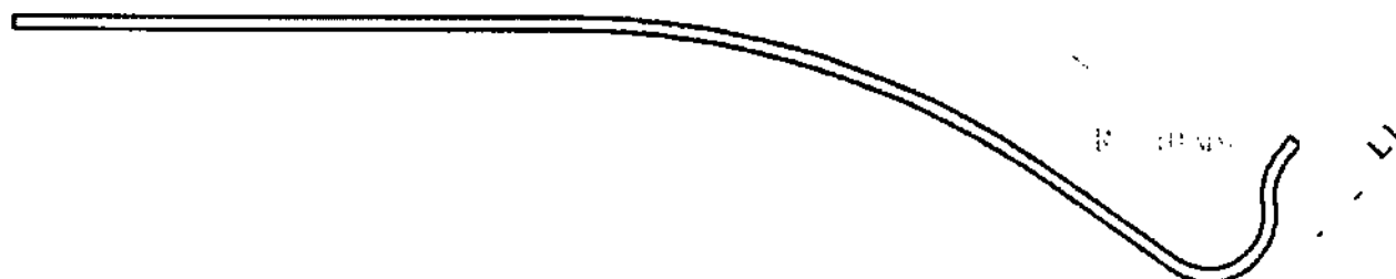
Рисунок А.4 – Вид дистального конца диагностических катетеров с конфигурацией дистального конца: AMPLATZ RIGHT: AR I, AR II, AR III и проводниковых катетеров с конфигурацией дистального конца: AMPLATZ RIGHT: AR 1.0, AR 2.0, AR 3.0; AMPLATZ LEFT RIGHT 1.2: ALR 1.2.
