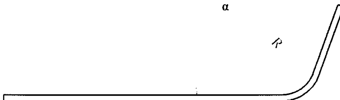
Рисунок А.10 – Вид дистального конца диагностических катетеров с конфигурацией дистального конца: SONES I, SONES II, SONES III: SON I, SON II, SON III и проводниковых катетеров с конфигурацией дистального конца: SONES CURVES 1, SONES CURVES 2, SONES CURVES 3: SON 1, SON 2, SON 3.
