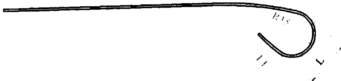
Рисунок А.19 – Вид дистального конца проводниковых катетеров с конфигурацией дистального конца: JUDKINS LEFT CURVED: JLC 3.5, JLC 4.0, JLC 4.5, JLC 5.0.
