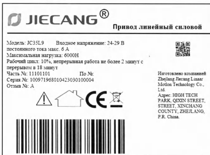
Пример маркировки на корпусе линейного силового привода на русском языке
