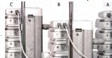
Рис. 2: Три колонны соединены правильно, кабели не пересекаются, разъемы на крышке выбраны правильно.
