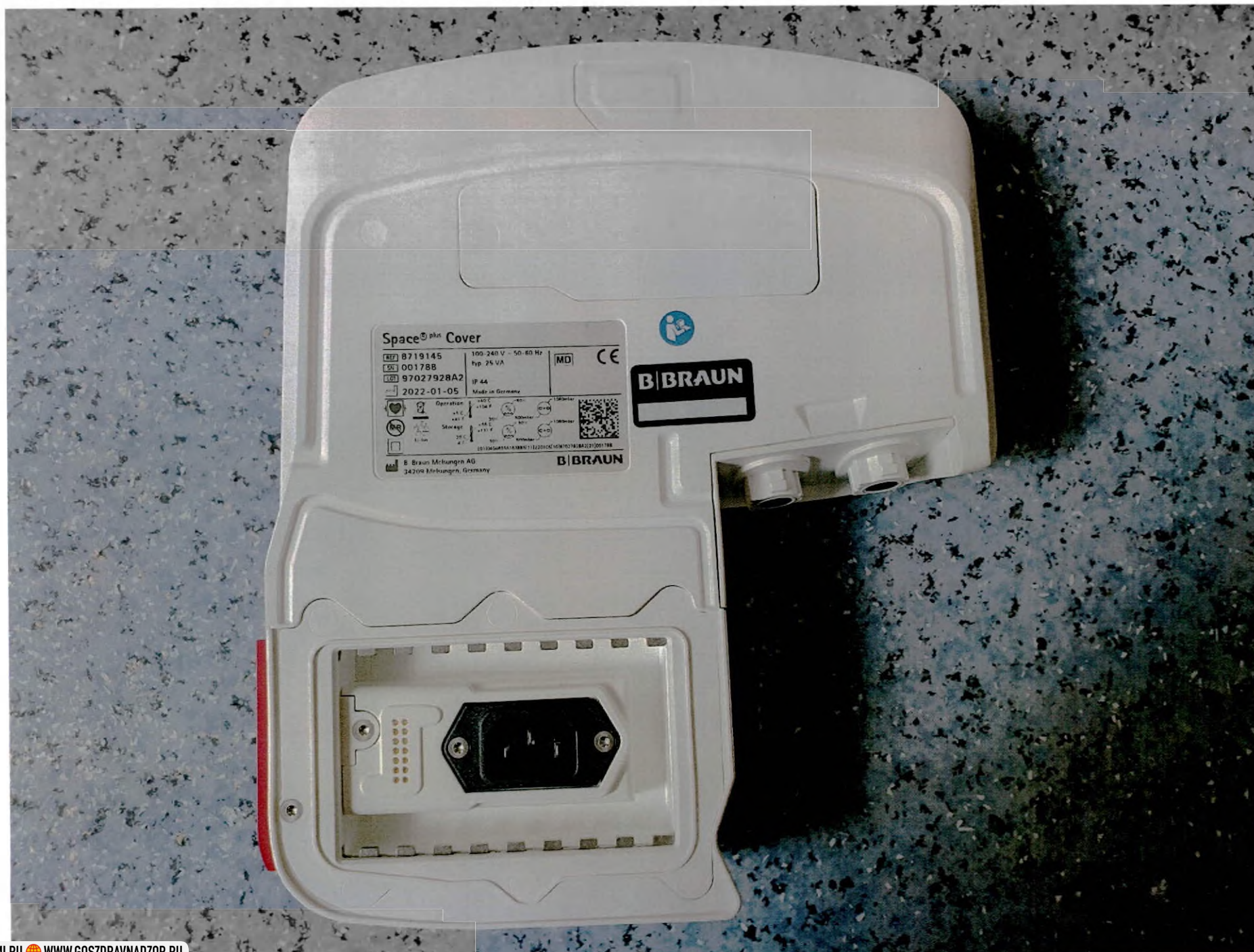
Крышка Спэйс плюс (Space plus Cover), вид снизу, маркировка
