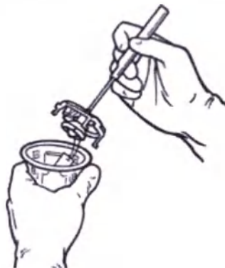
Рисунок 15. Извлечение клапана и крепежного воротника из внутреннего контейнера.
