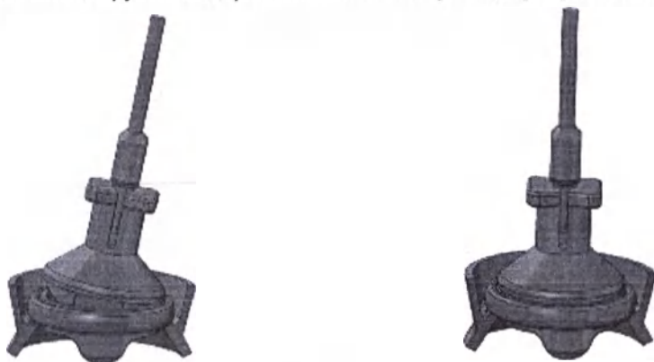
Рисунок 20. Неправильно вставленный ротатор-держатель (слева). Правильно вставленный ротатор-держатель (справа).
