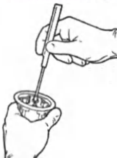
Рисунок 14. Установка рукоятки держателя в держатель клапана.
