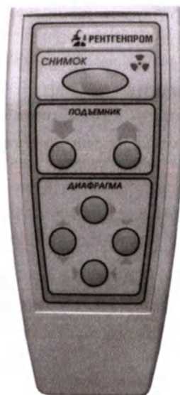
Рисунок 6.2 – Пульт дистанционного управления диафрагмой в кабине из композитных материалов
