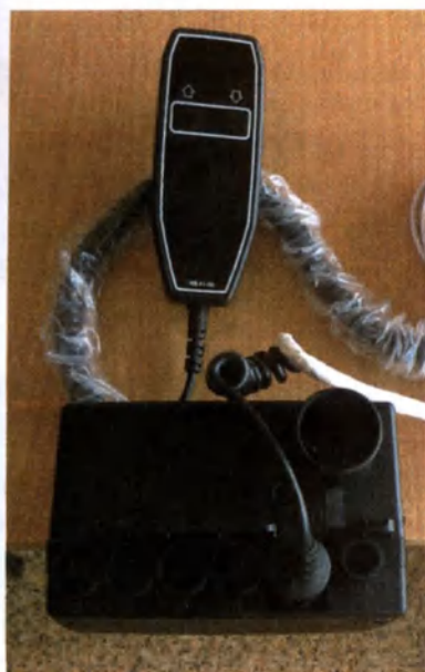
Рисунок 6.1 – Пульт дистанционного управления подъемником в металлической кабине
