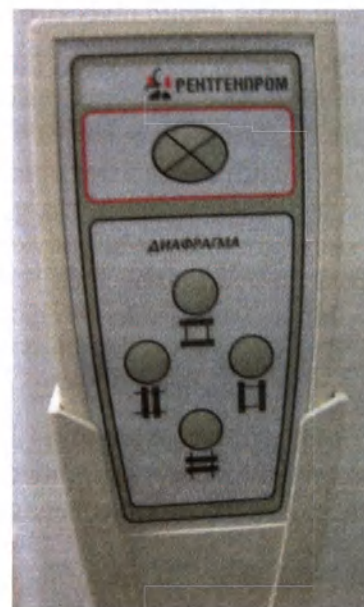
Рисунок 6.3 – Пульт дистанционного управления диафрагмой в металлической кабине
