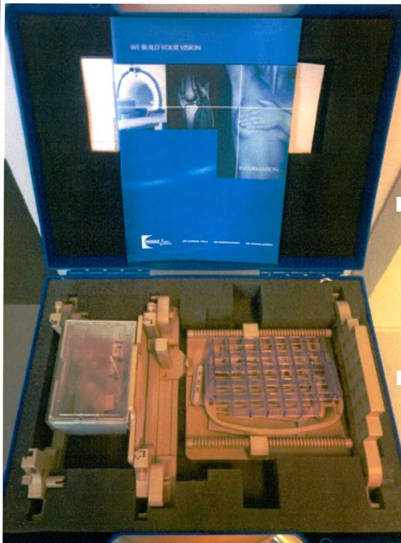
31. Набор тестовый для проведения биопсии молочных желез, в составе: - пластина для введения; - горизонтальные и вертикальные пластины-перекладки; - игольная направляющая (метод post/pillar) - регулируемые по высоте решетки многоразовые и/или одноразовые (метод grid); - крепежная деталь рамы.
