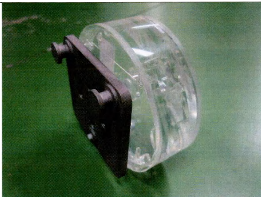
Фотографическое изображение фантома для измерения толщины среза и функции передачи модуляции (MTF)
