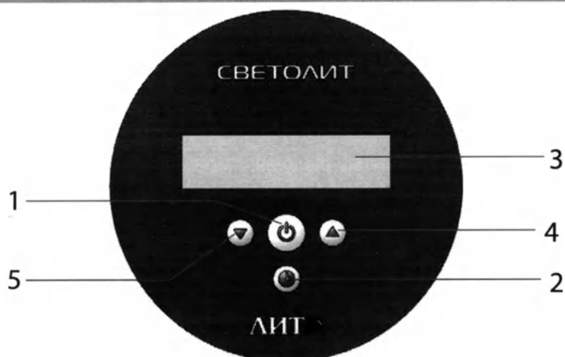
Рисунок 7.2. Расположение элементов на панели управления: 1-включение УФ-ламп; 2- индикация времени наработки; 3-цифровое табло; 4-увеличение времени работы; 5-уменьшение времени работы
