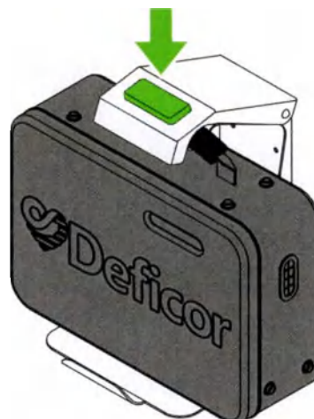
Рисунок 6.9 — Нажмите кнопку для освобождения ручки изделия
