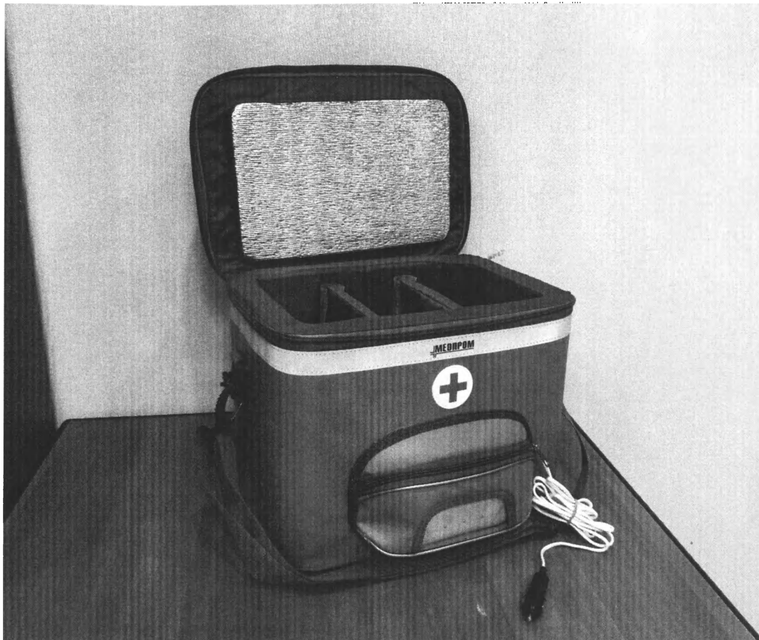
Фотография 6. Общий вид. Контейнер с открытой крышкой и вынутым из кармана несъемным кабелем питания.
