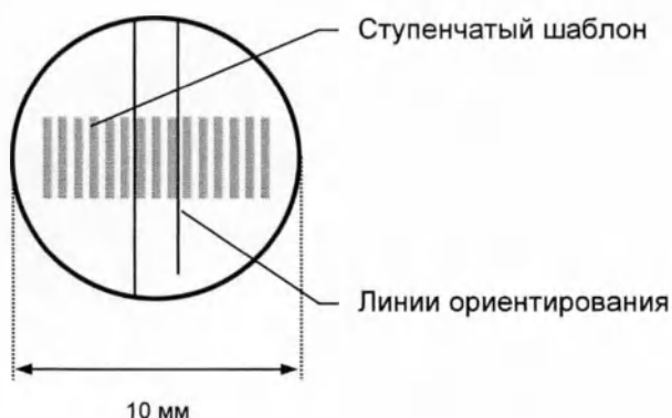
Рисунок 51: Тестовый диск (схематический вид сверху ступенчатого шаблона)
