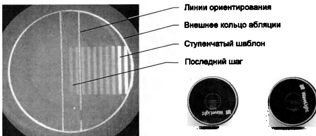
Рисунок 52: Проверка абляции пройдена (вид сверху) - Положение WaveLight Logo не имеет значения
